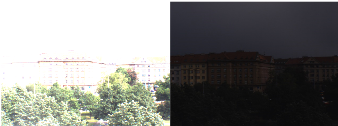
Obr. 6.8: Snímky pořízené s různou dobou expozice (vlevo delší doba a vpravo kratší doba)
