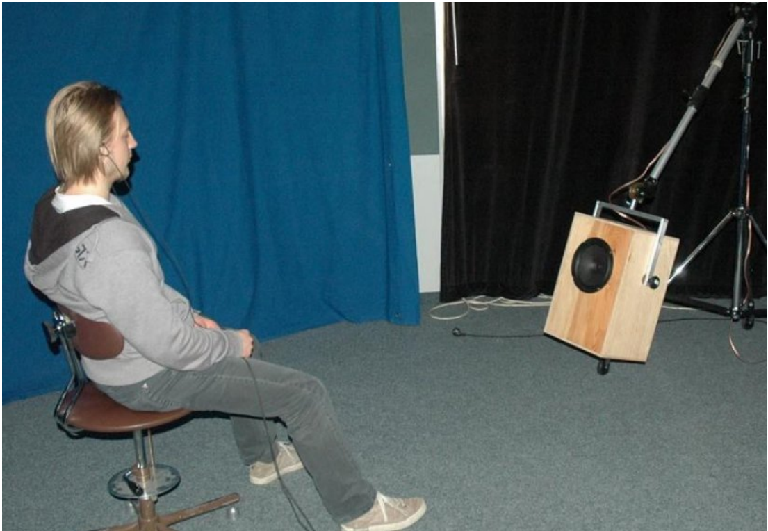
Obr. 7. Sestava měření HRTF pro ČVUT. Převzato z [29].
