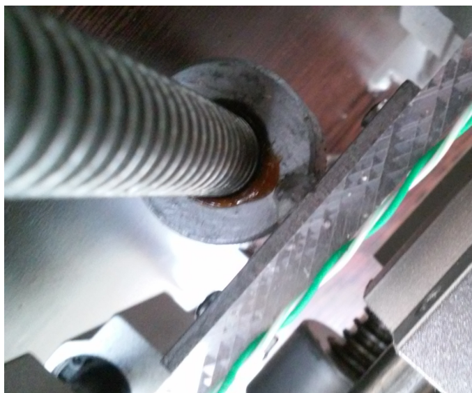
Obr. 2.8: Detail trapézovej tyče a matice s pásovinou
