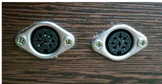
Obr. 2.12: Detail konektorov DIN
