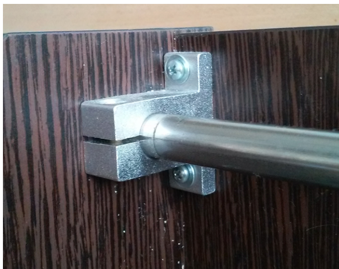
Obr. 2.2: Detail spojenia hliníkového úchyty a vodiacej tyče
