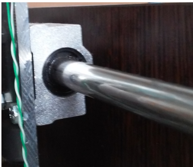
Obr. 2.4: Detail bloku s lineárnym ložiskom a vodiacej tyče
