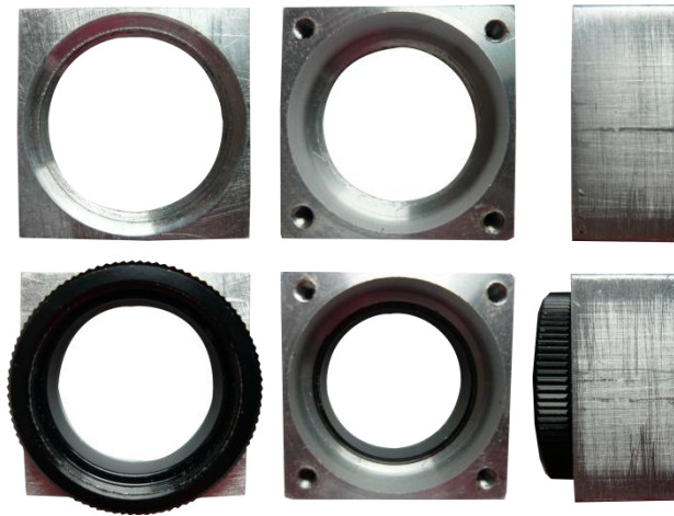
Obr. 21 Podložka pod objektív, zľava TOP, BOTTOM, SIDE
