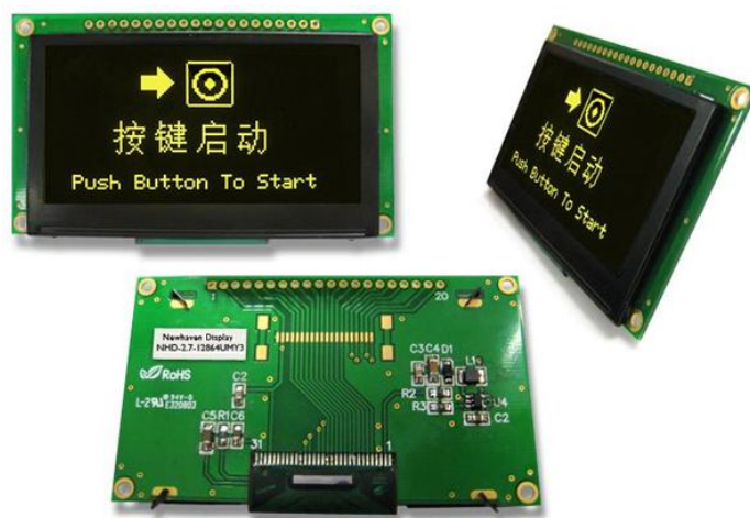
Obr. 16 – Displej - NHD-2.7-12864UMY3, Zdroj: http://www.newhavendisplay.com/
