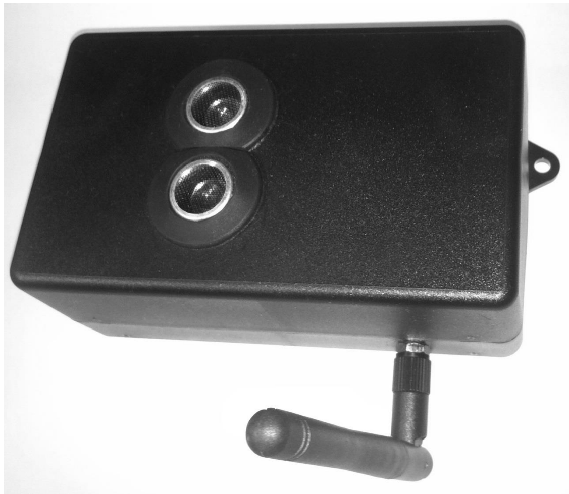
Obr. 18 Prototyp bezdrátového senzoru výšky hladiny připojeného k síti Wi-Fi.
