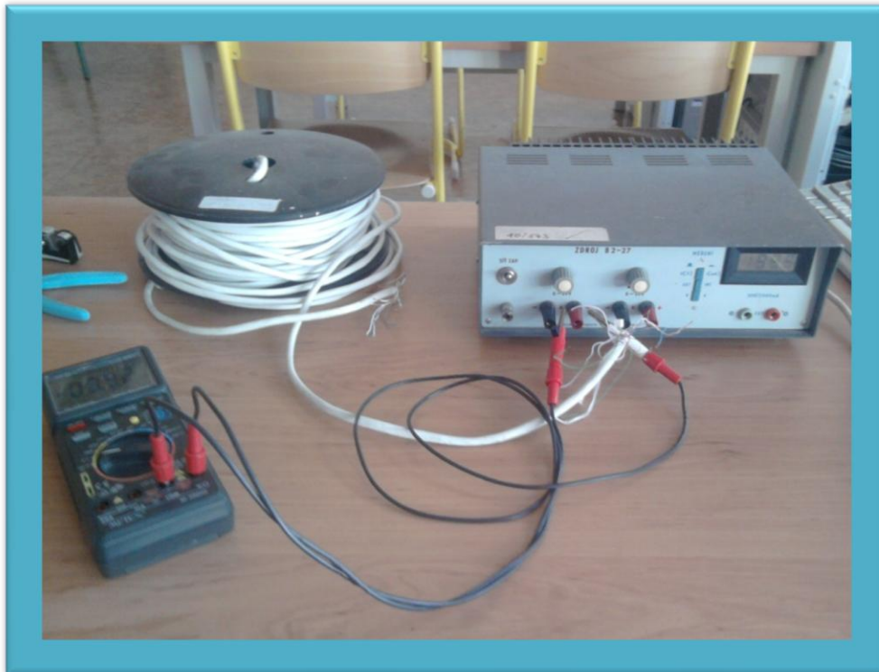
Obrázek 12: Měření úbytku napětí na jednom páru (UTP SYKFY)
