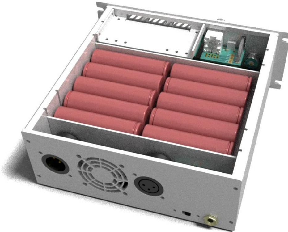
Obrázok 2.15: spodný pohľad na modul generátora
