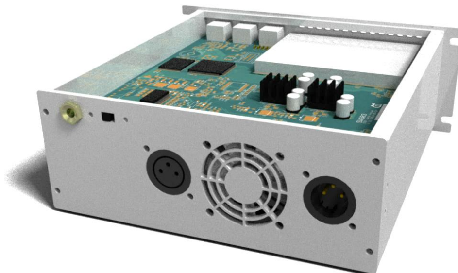
Obrázok 2.14: zadný pohľad na modul generátora
