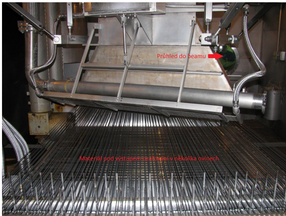
Obrázek 9: Materiál v několika ovinech pod výstupem ozařování
