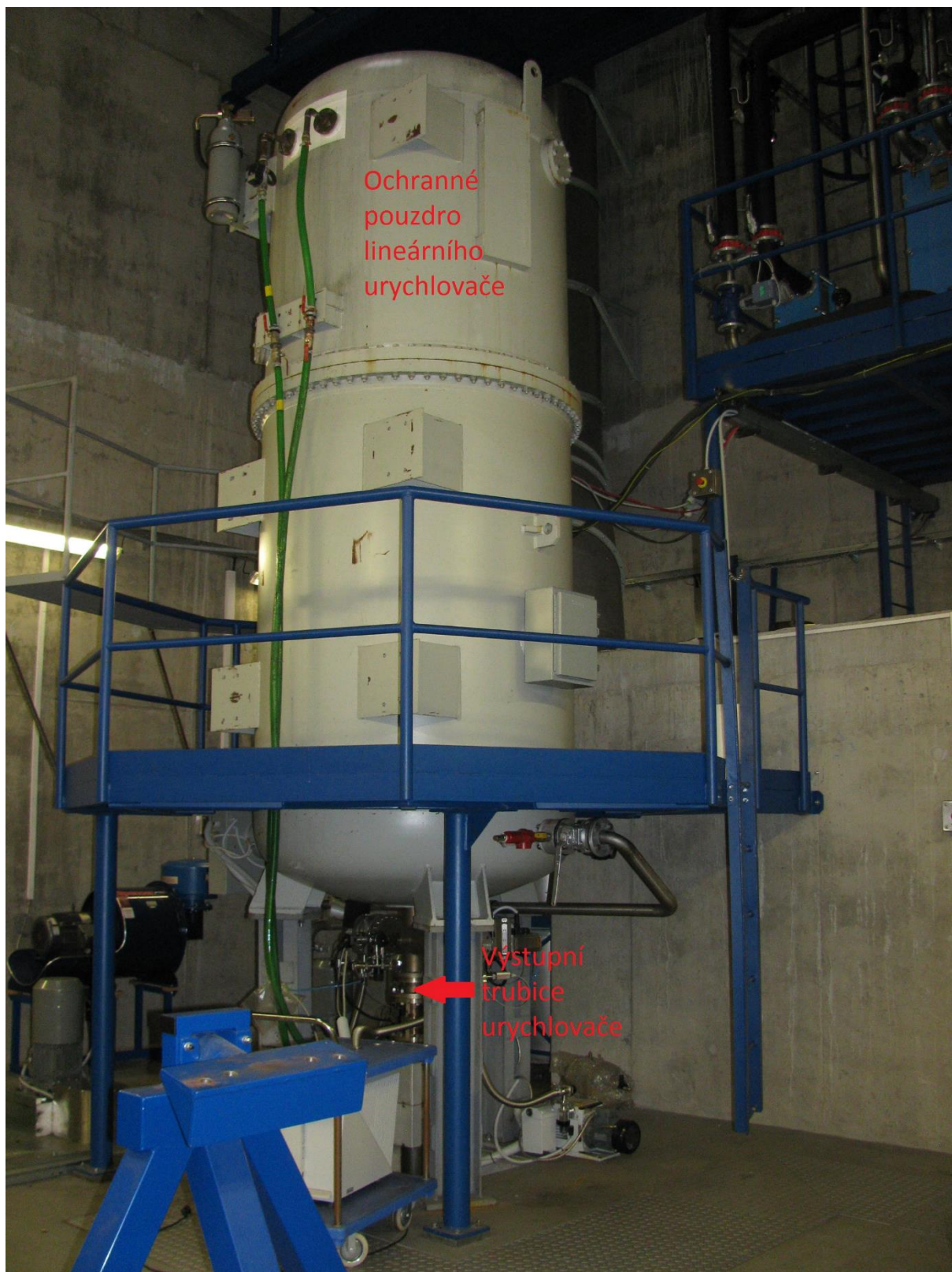
Obrázek 7: Vnitřní pohled na lineární urychlovač v ochranném pouzdře
