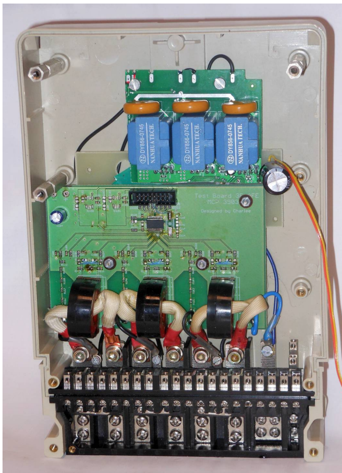
Obrázek 18: Třířázová měřicí deska v krabici
