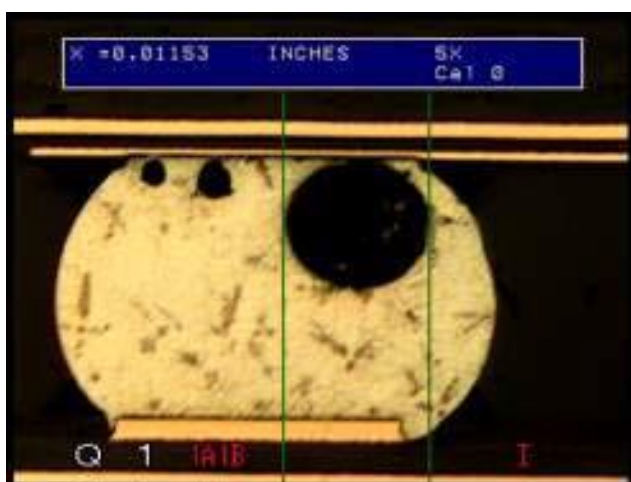
Obrázek 21 Makrovoidy v BGA spoji (21)
