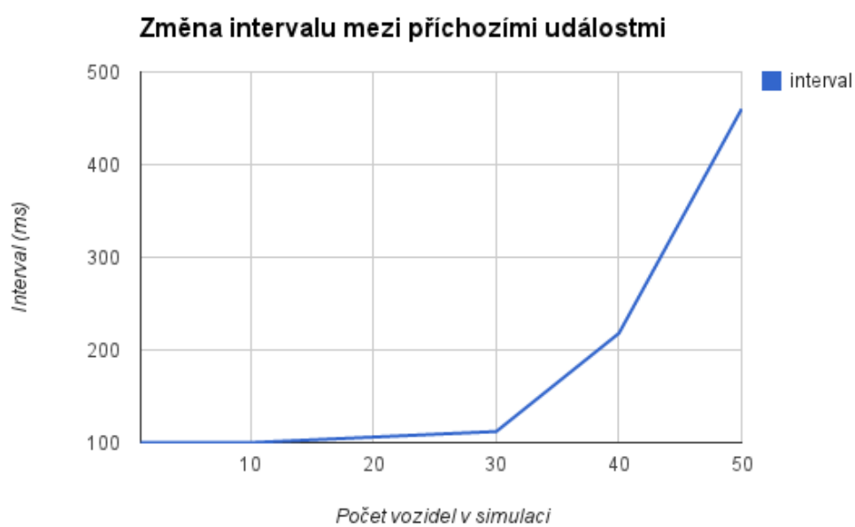
Obrázek 29. Výsledek zatěžkávacího testu reprezentovaný nárůstem prodlevy mezi příchozími událostmi pro jedno vozidlo v závislosti na počtu vozidel v simulaci. Požadovaný interval je 100ms.
