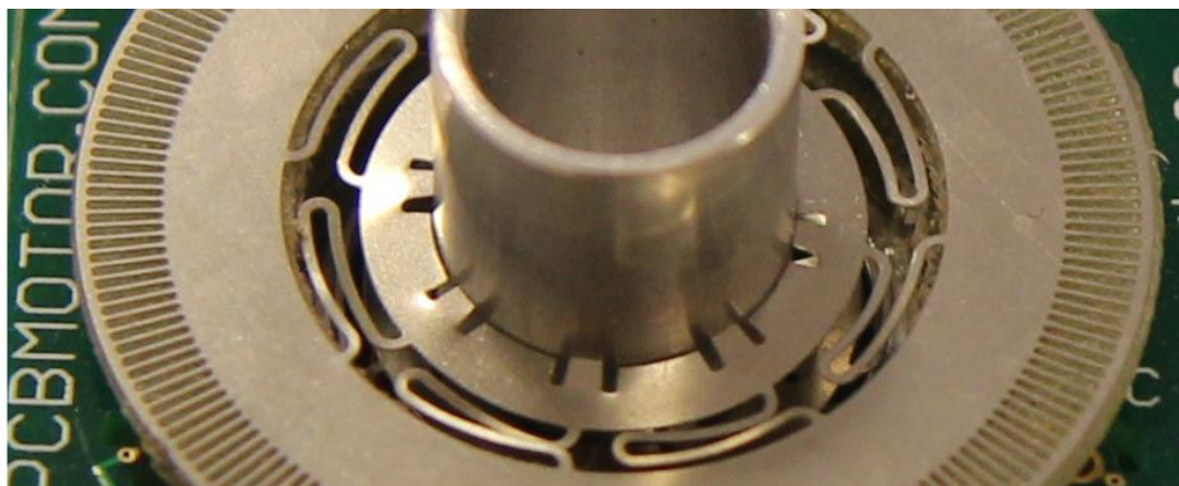
Obr. 11 Rotor s prázdným středem, pružinou a rotačním enkodérem (převzato z [6])
