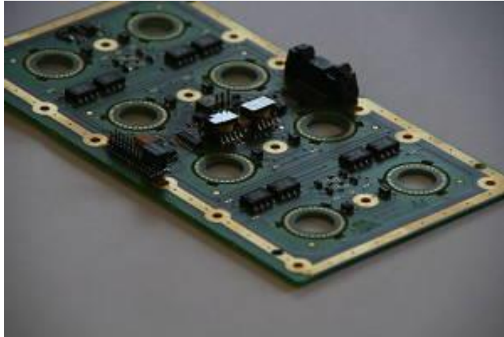
Obr. 1 DPS se statory PCB motorů (převzato z [1])
