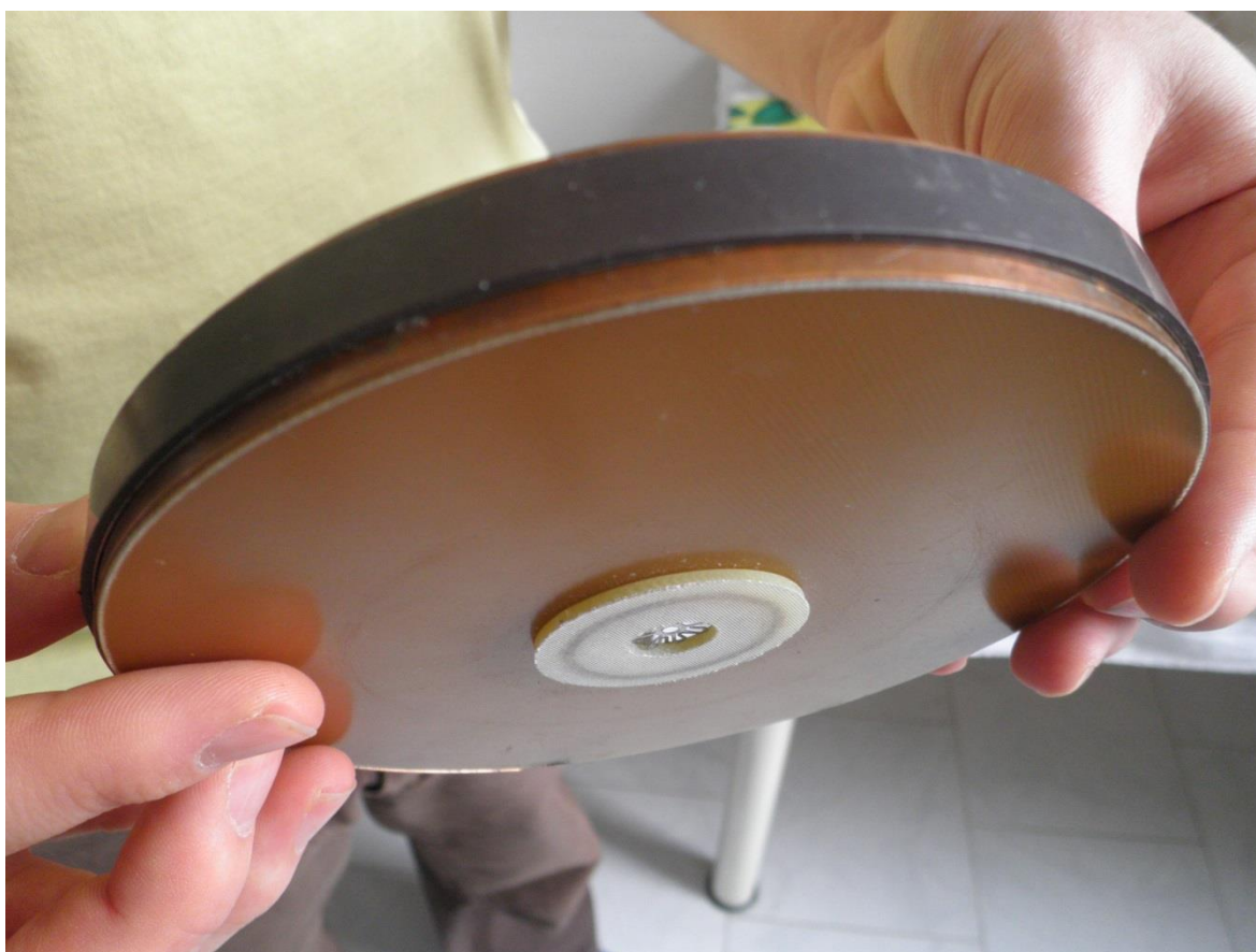
Obr. 29 Vyrobený kotouč s magnetickým páskem a rotorem motoru
