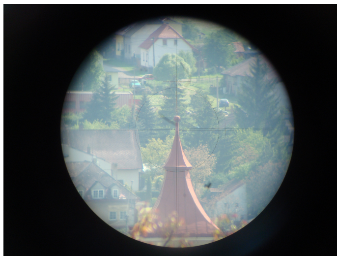
Obrázek C.3: Zaměřování optické osy DI-Flux na značku se známým azimutem.
