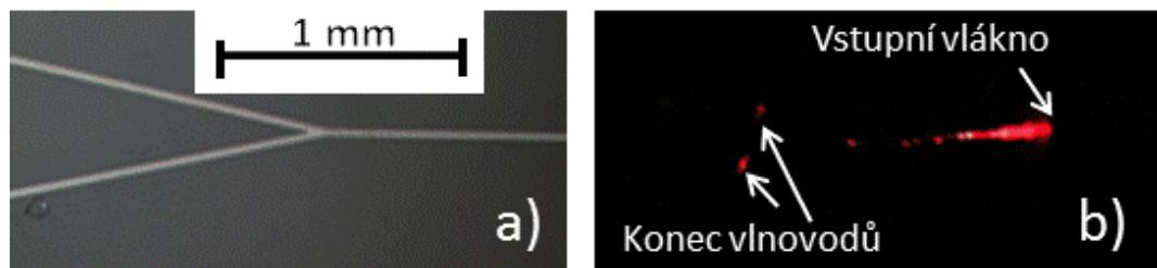
Obrázek 3.10: Vyrobená struktura optické rozbočnice ovlivněním polymerního optického vlnovodu působením elektromagnetického pole, a) fotografie struktury, b) struktura při průchodu signálu 632,8 nm.
