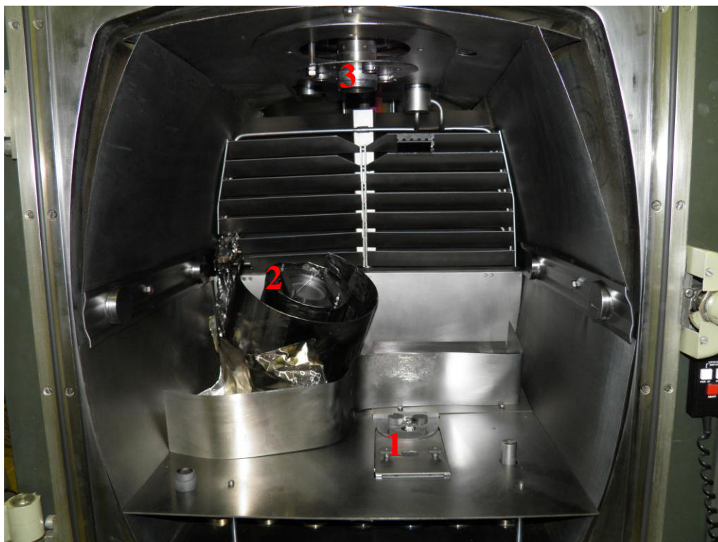
Obr. 17: Pohled na komoru aparatury LE IBAD, ve které se nachází vypařovací zařízení (1), iontový zdroj (2) a manipulátor (3)
