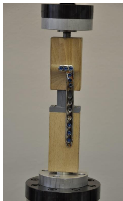
Obr. 7.19 Dynamické zkoušky dlah pro osteosyntézu dlouhých kostí – detail testované sestavy tibiální dlahy a přípravků (vlevo), umístění v testovacím systému MTS Mini Bionix (vpravo) [62].
