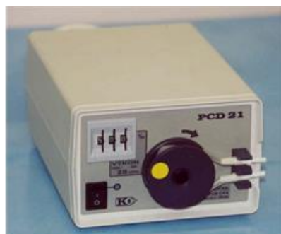
Obr. 5.8 Peristaltické čerpadlo PCD 21 používané při tribologické zkoušce Ring on Disc. Foto autor.
