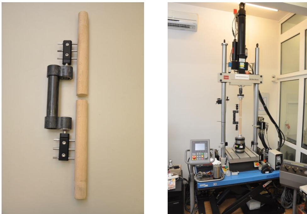
Obr. 8.2 Sestava nově vyvinutého zevního fixátoru vyrobeného z C/PPS kompozitu a uhlíkové trubky (vlevo), testovací systém MTS 858 Mini Bionix s osazeným vzorkem před zatěžováním (vpravo) [285].
