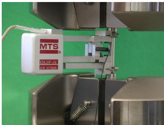
Obr. 2.2 Vzorek z ušlechtilé oceli při tahové zkoušce dle ČSN EN ISO 6892-1 [15] upnutý v hydraulických čelistech testovacího systému MTS Mini Bionix a osazený extenzometrem pro měření podélné deformace. Foto autor.
