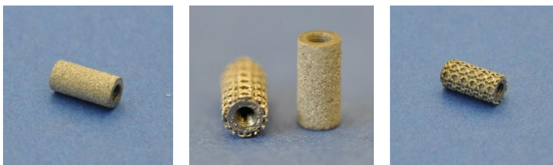
Obr. 6.12 Dva typy titanových implantátů s vnitřním závitem M2 pro hodnocení adheze injekčně aplikovatelného porézního kostního cementu (uprostřed) – typ I vyrobený konvenční technologií a opatřený plasmovým nástřikem hydroxyapatitu (vlevo), typ II vyrobený aditivní technologií 3D tisku s povrchovou trabekulární strukturou (vpravo) [222].
