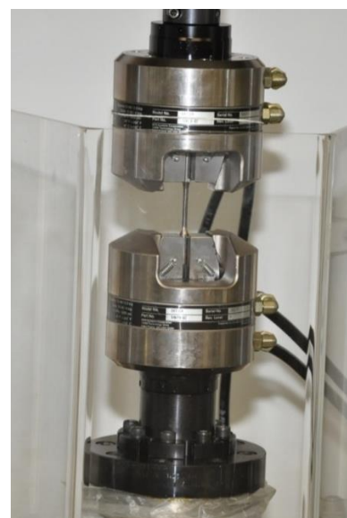
Obr. 2.17 Zkušební těleso pro únavové zkoušky s uvedenými rozměry (vlevo). Sestava pro zkoušení únavy v testovacím systému MTS MiniBionix 858.02 při použití hydraulických čelistí. Zdroj autor.
