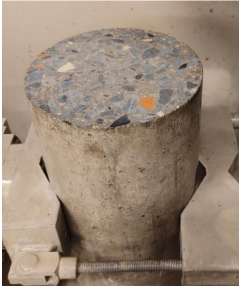
Obr. č.47 – Těleso betonu s recyklovaným smíšeným kamenivem (RA-M2-1) – vlevo: spodní povrch po broušení, vpravo: horní povrch po broušení (foto autorky).
