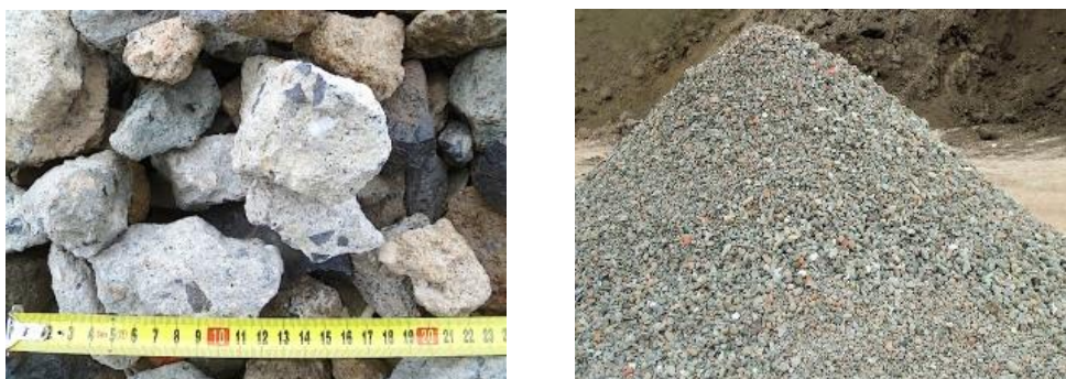
Obr. č.19 – Vlevo: betonový recyklát frakce 32/63 mm [48]; vpravo: betonový recyklát frakce 0/63 mm [49].
