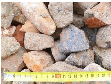
Obr. č.22 – Vlevo: recyklované cihelné kamenivo 32/63 mm [51]; vpravo: směsný recyklát 0/63 mm [52].
