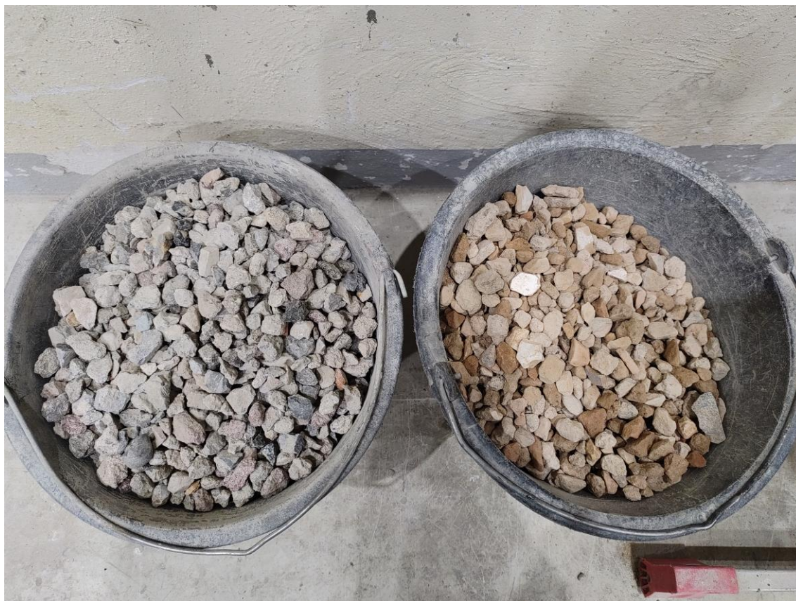
Obr. č.39 – Betonový a směsný recyklát frakce 8/16 mm (foto autorky).
