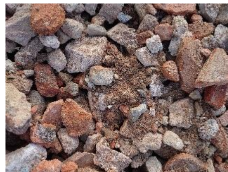
Obr. č.22 – Vlevo: recyklované cihelné kamenivo 32/63 mm [51]; vpravo: směsný recyklát 0/63 mm [52].
