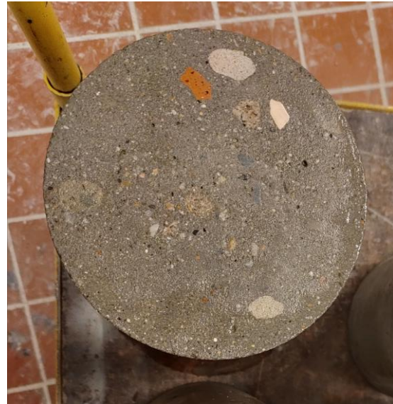
Obr. č.47 – Těleso betonu s recyklovaným smíšeným kamenivem (RA-M2-1) – vlevo: spodní povrch po broušení, vpravo: horní povrch po broušení (foto autorky).
