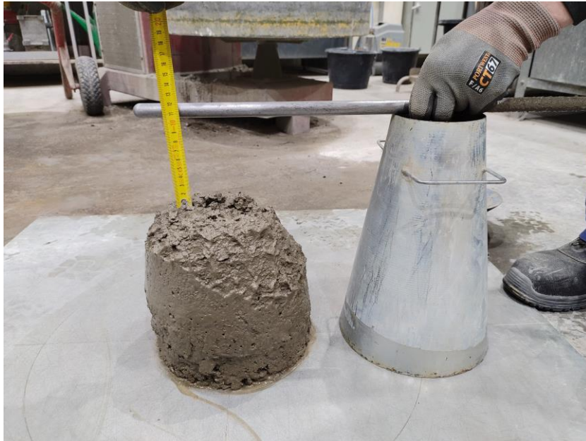
Obr. č.43 – Ukázka zkoušky sednutí kužele – záměs RA-M2 – beton s recyklovaným směsným kamenivem (foto autorky).
