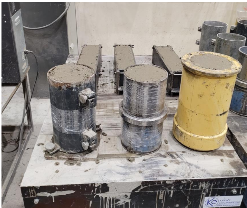
Obr. č.44 – Uložení betonové záměsi do forem (foto autorky).
