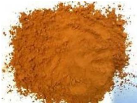
Obr. č.20 – Vlevo: ultra jemné recyklované keramické částice, velikost částic pod 0,063 mm [50]; vpravo: jemné recyklované keramické kamenivo, velikost zrn mezi 0 a 4 mm [47].
