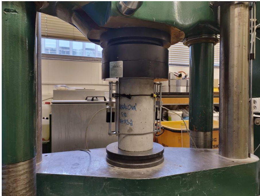
Obr. č.54 – Válcové těleso při zkoušce statického modulu pružnosti (foto autorky).
