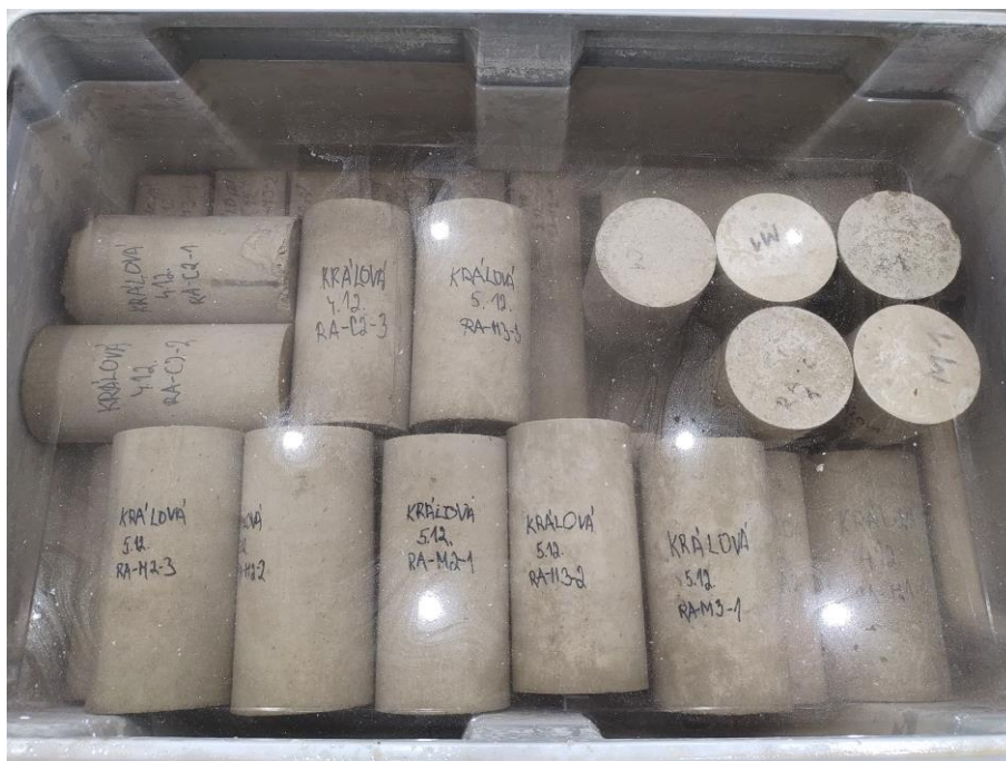
Obr. č.46 – Vzorky po odbednění, uložené do vody (foto autorky).
