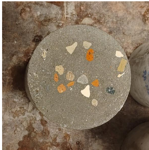
Obr. č.48 – Těleso betonu s recyklovaným smíšeným kamenivem (RA-M3-2) – vlevo: spodní povrch po broušení, vpravo: horní povrch po broušení (foto autorky).
