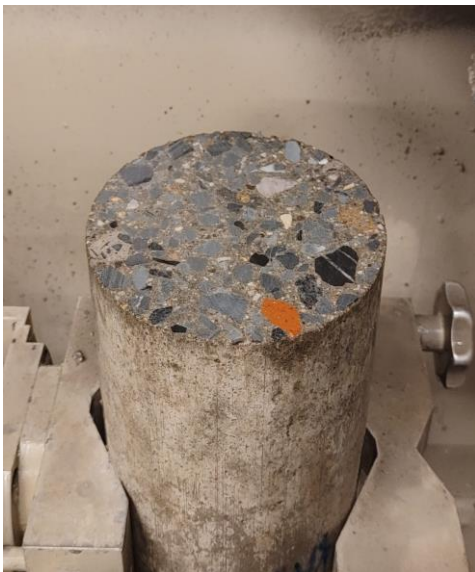
Obr. č.48 – Těleso betonu s recyklovaným smíšeným kamenivem (RA-M3-2) – vlevo: spodní povrch po broušení, vpravo: horní povrch po broušení (foto autorky).
