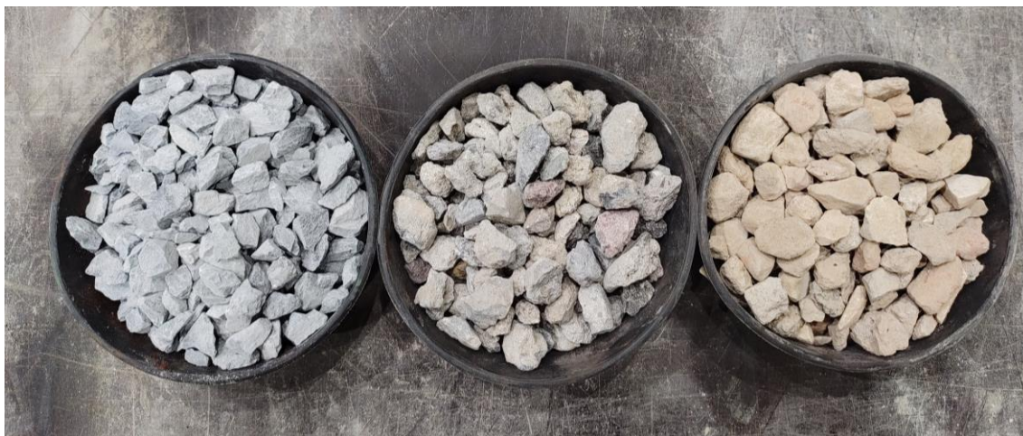
Obr. č.40 – Zleva: přírodní kamenivo frakce 8/16 mm; recyklované betonové kamenivo frakce 8/16 mm; recyklované směsné kamenivo frakce 8/16 mm (foto autorky).
