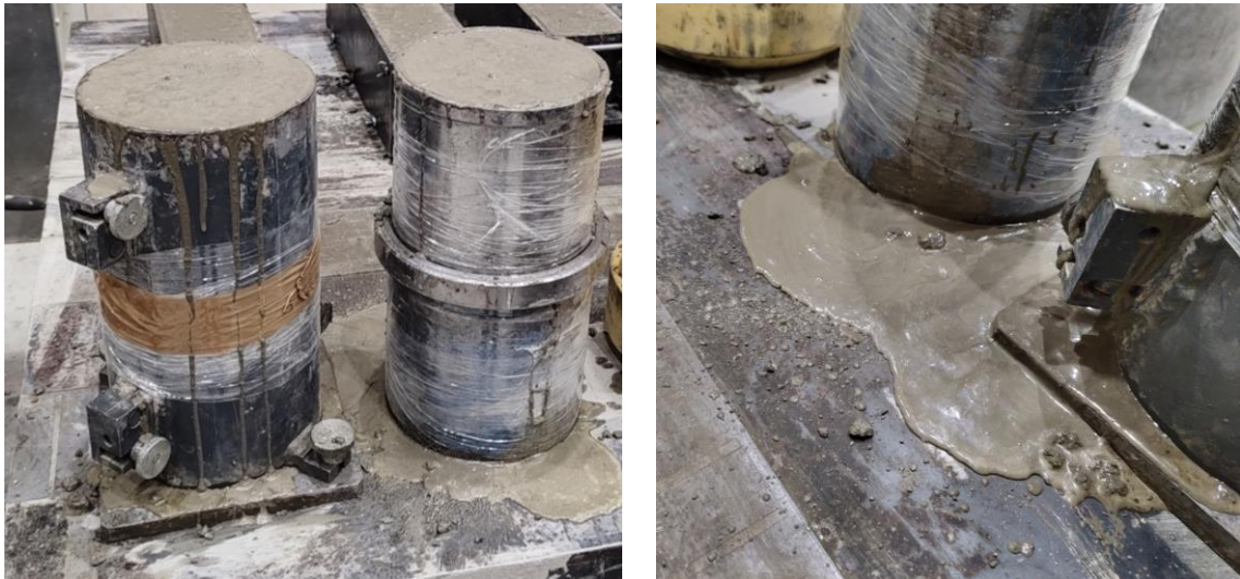
Obr. č.45 – Cementové mléko vytékající z netěsnících forem (foto autorky).
