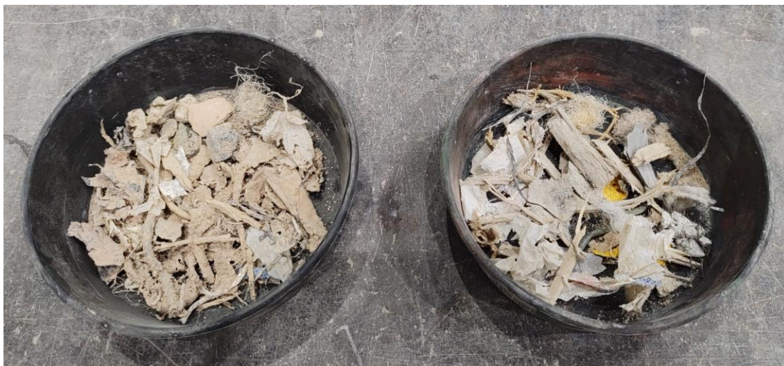
Obr. č.41 – Zleva: nečistoty ve směsném recyklátu; nečistoty v betonovém recyklátu (foto autorky).
