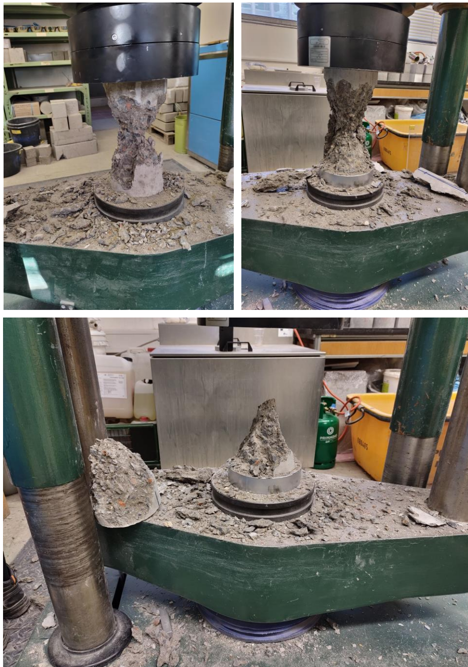
Obr. č.49 – Válcová tělesa po zkoušce pevnosti v tlaku (foto autorky).
