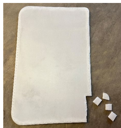
Obrázek 7-8 Vzorky výstužné desky sedáku pro materiálovou analýzu
