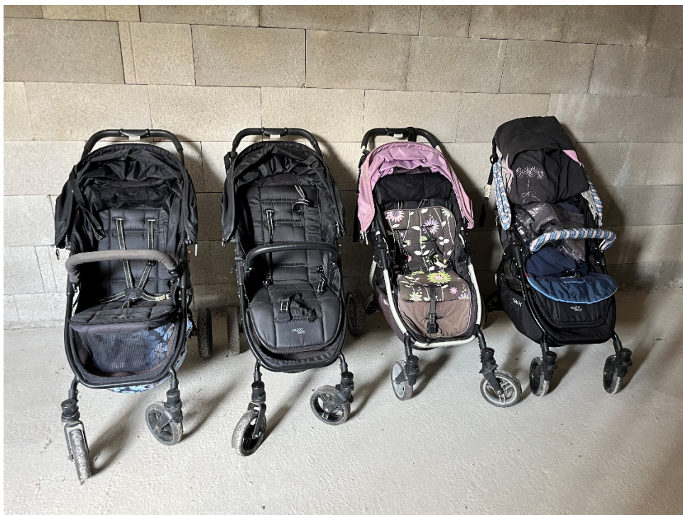
Obrázek 8-1 Kočárky podrobené požární zkoušce
