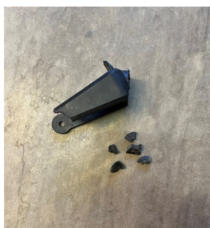
Obrázek 7-10 Vzorky prvku pro upevnění předního kola pro materiálovou analýzu
