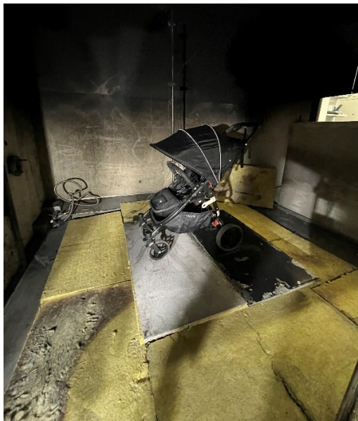
Obrázek 8–5 Ochrana podlahy a kabelových tras před požárem
