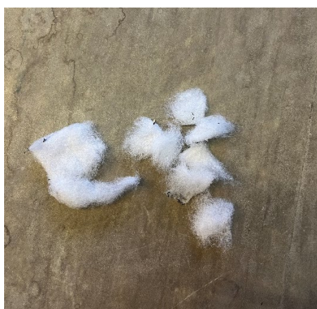
Obrázek 7-9 Vzorky spodní výplně sedáku pro materiálovou analýzu
