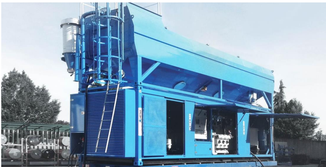
Obrázek 32: automatická míchárna Metax JM40 s rozplavovačem [15]
