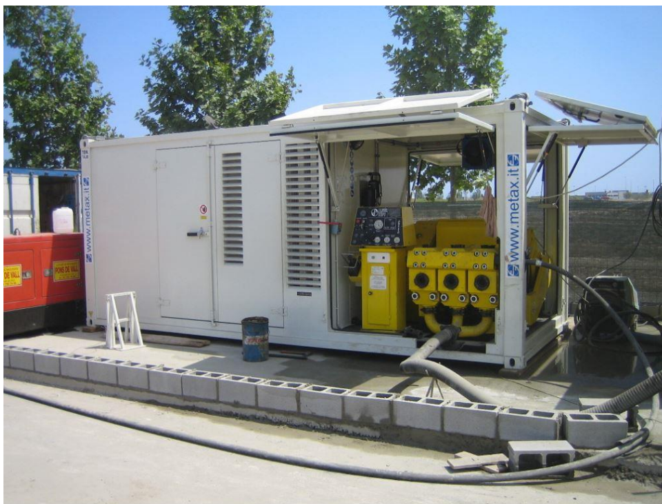
Obrázek 33: inekční čerpadlo Metax MP7-770S-8 [16]
