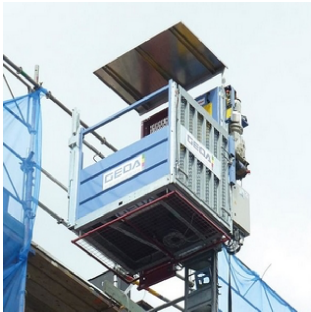
Obr. č. 10 Stavební výtah GEDA 300 Z/ZP svislá [11]
