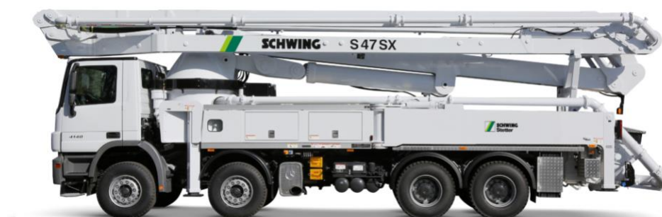
Obr.11: Autočerpadlo Schwing S 47 SX [6]
