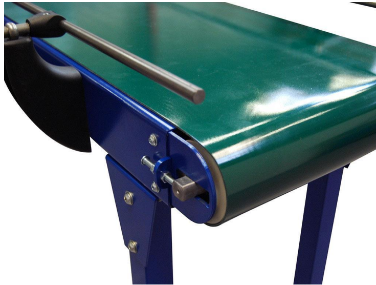
Obr. 29.: Napínání pásu pomocí šroubů [38]
