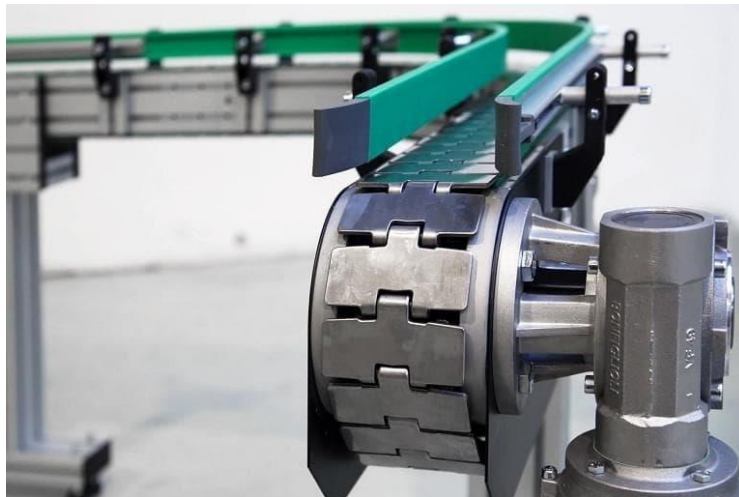
Obr. 32.: Článkový dopravník Alutec [41]
