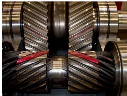
Obr. 2.: Čelní ozubená kola se šikmými zuby [5]
