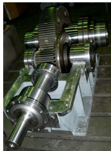
Obr. 14.: Kuželo - čelní převodovka [19]
