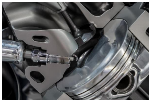
Obr. 9 - Pohled na spalovací komoru zážehového motoru [15]
