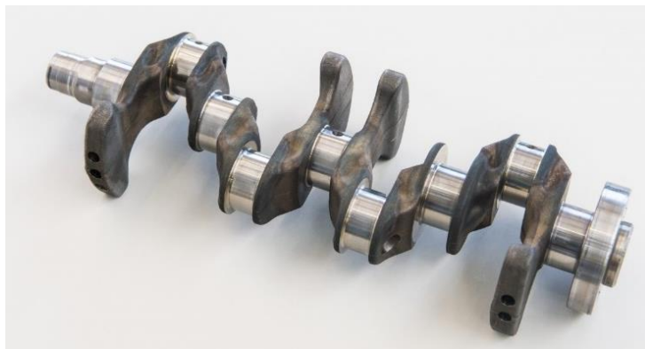
Obr. 42 - Litý klikový hřídel motoru Škoda [28]
