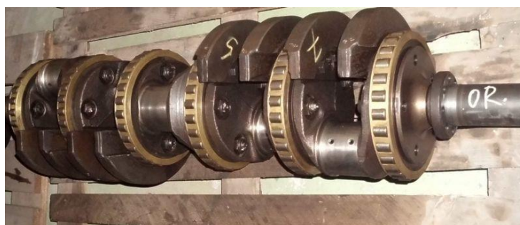
Obr. 43 - Skládaný klikový hřídel motoru Tatra 815 [29]
