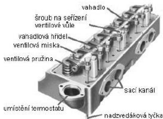
Obr. 45 - Konstrukce hlavy válců pístového motoru chlazeného kapalinou [13]
