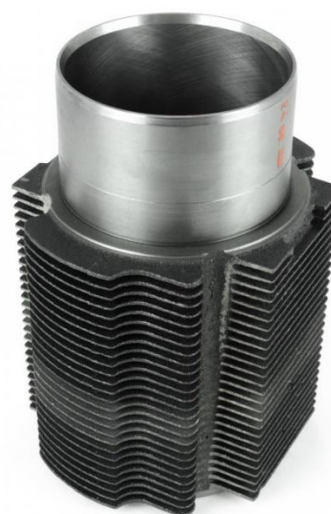
Obr. 47 - Válec vzduchem chlazeného motoru T815 [32]
