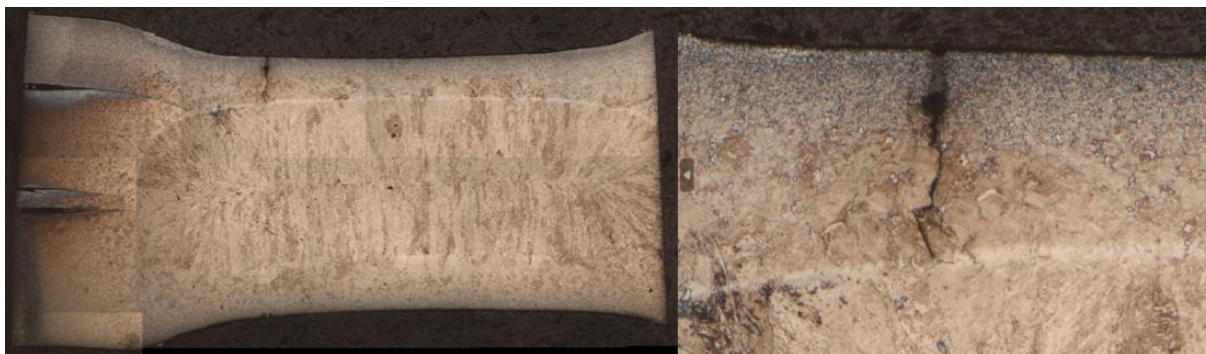
Obrázek 47 - Snímek metalografického výbrusu vzorku 135: Trhлина a její detail
