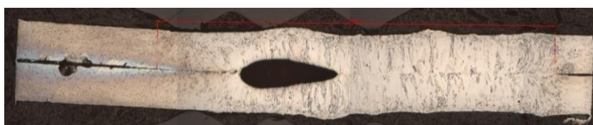
Obrázek 45 – Snímek metalografického výbrusu vzorku 3.1: Dutina, převýšení svaru
