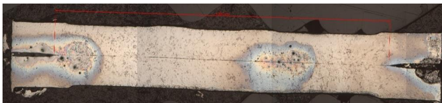
Obrázek 46 - Snímek metalografického výbrusu vzorku 4.5: Studený spoj
