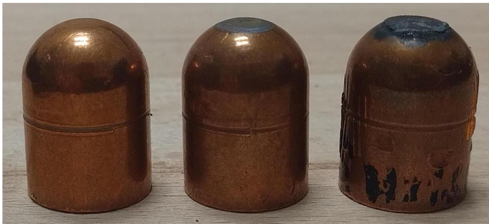
Obrázek 27 - Elektrodové hroty (zleva: nové, optimálně opotřebené, opotřebené)
