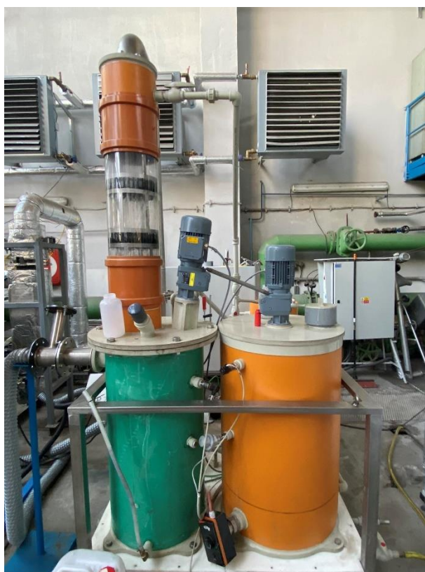
Obr. 10 Poloprovozní jednotka (vlevo absorbér, vpravo nádoba 1)
