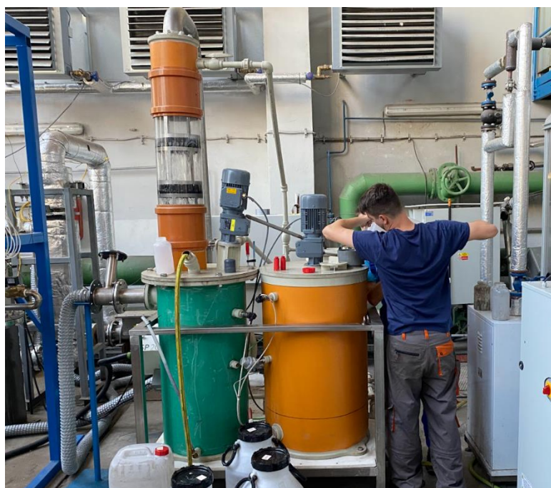
Obr. 17 Plnění zásobníku sádrovcovou suspenzí
