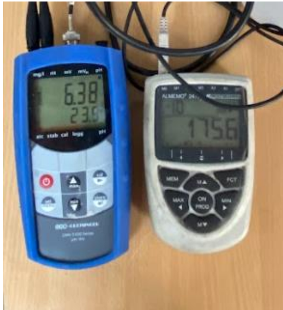
Obr. 11 Použitý pH-metr (vlevo) a ORP-metr (vpravo)
