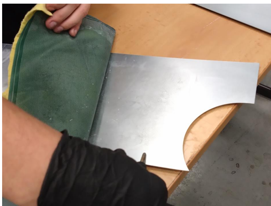
Obrázek 38. Průběžná kontrola sítě během nanášení
