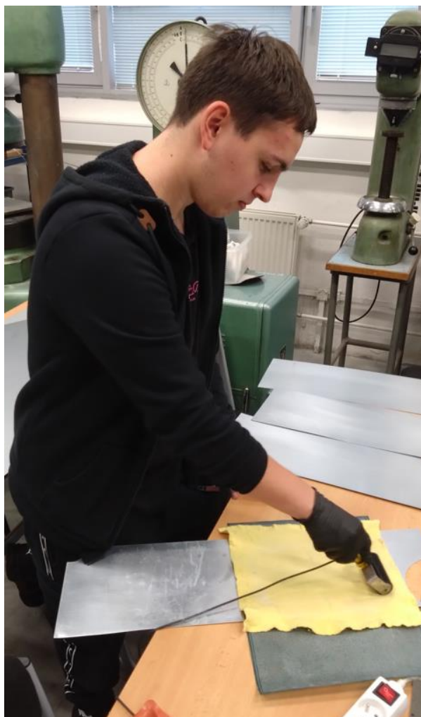
Obrázek 37. Postup nanášení měrné sítě
