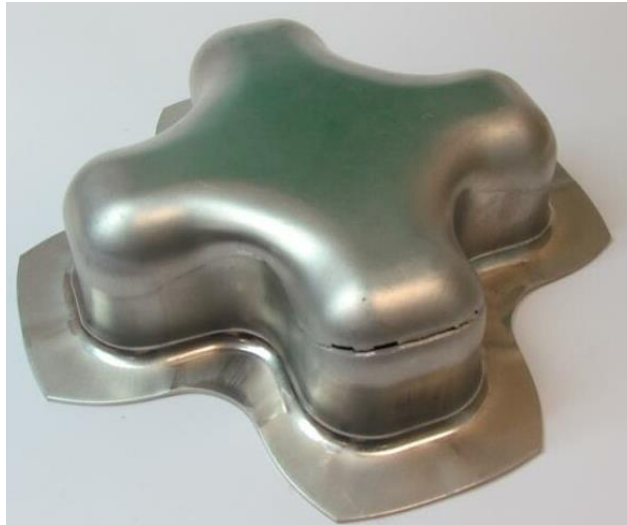
Obrázek 24. Ukázka výrobku Cross-die tažníku s kritickým místem porušení [21]
