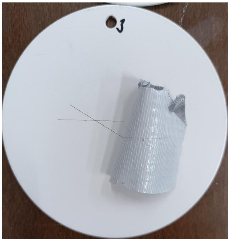
Obrázek 15: Průběh zkoušky křížovým řezem [foto autora práce]
