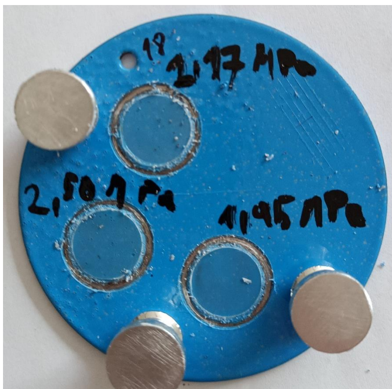
Příloha 18: Vzorek 18 po provedení odtrhové zkoušky
