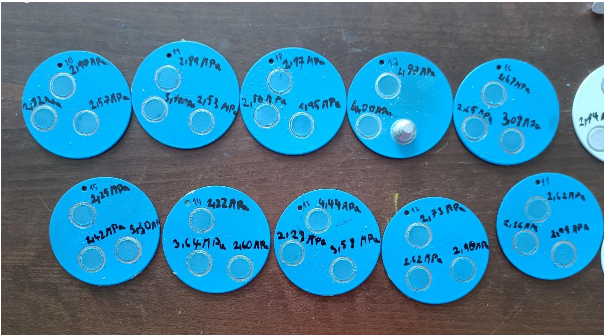
Obrázek 18: Vzorky s termoplastovým povlakem po provedení zkoušky odtrhem [foto autora práce]
