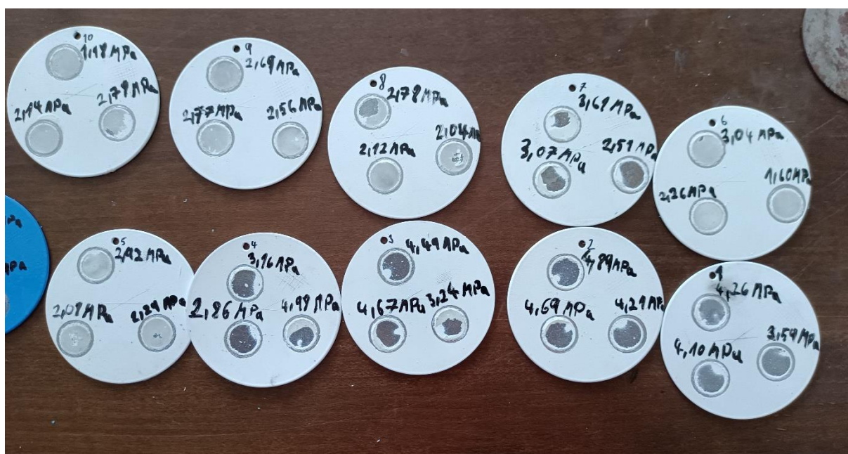
Obrázek 17: Vzorky s termosetovým povlakem po provedení zkoušky odtrhem [foto autora práce]
