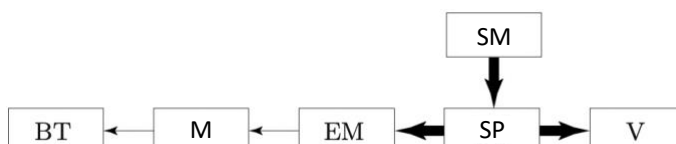
Obrázek 5 - Dobíjení baterie ( u < 0 ) (upraveno z [1])
