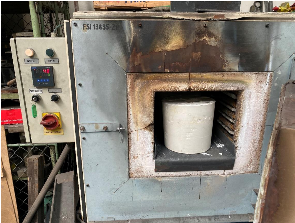
Obrázek 34: Nahřívání v kalici komorové peci
