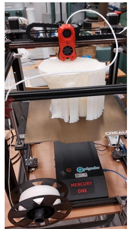
Obrázek 23: Tisknutí velkého modelu na 3D tiskárně Mercury One
