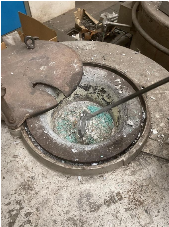
Obrázek 38: Přidávání soli kvůli oxidaci
