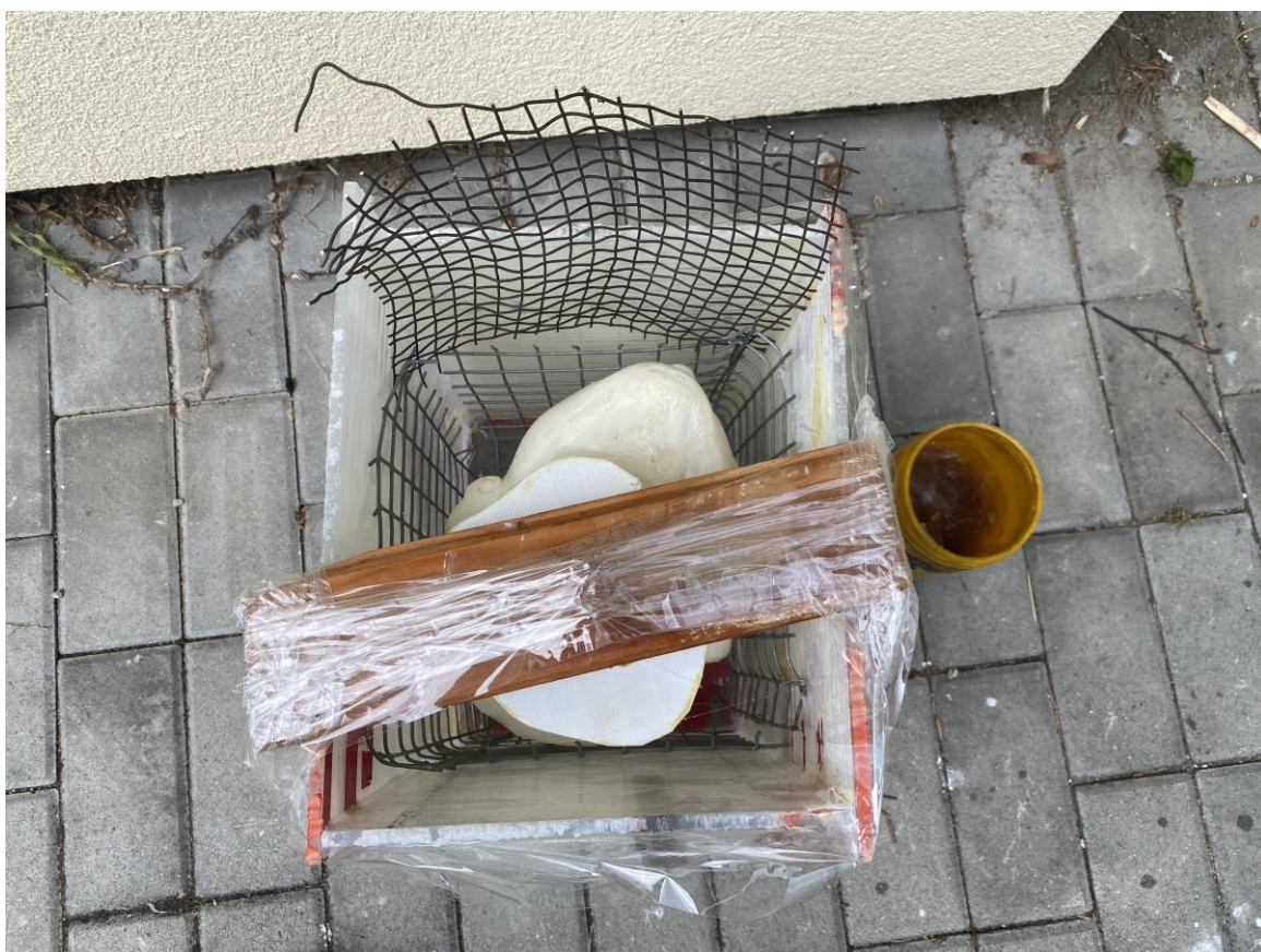
Obrázek 31: Uchycení, vložení pletiva a nanesení oleje na model a formovací rám
