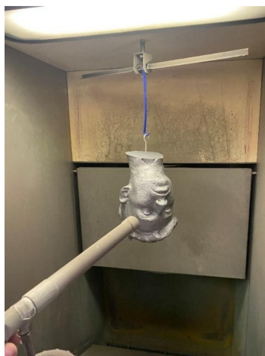
Obrázek 49: Nanášení práškového laku pomocí práškovací pistole
