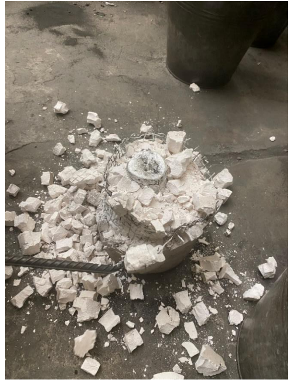
Obrázek 41: Rozbití sádrové formy
