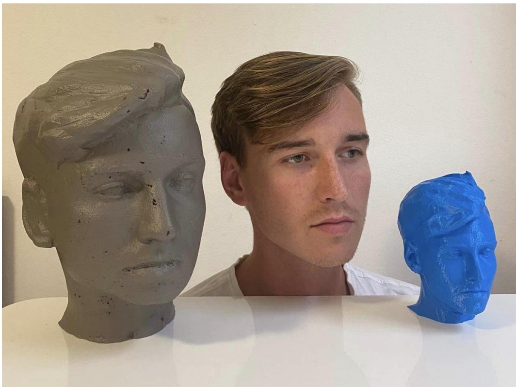
Obrázek 54: Porovnání výsledného výrobku, skenované osoby a plastového 3D modelu
