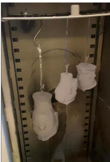
Obrázek 50: Vytvrzování práškového laku v peci
