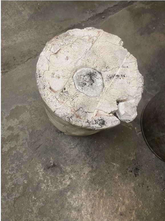
Obrázek 40: Ztuhlý odlitek po odlití
