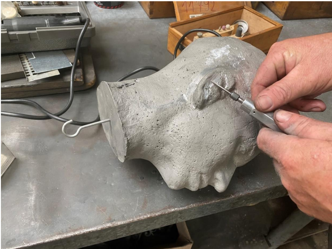
Obrázek 44: Frézování s přímou bruskou a doděláné detailů
