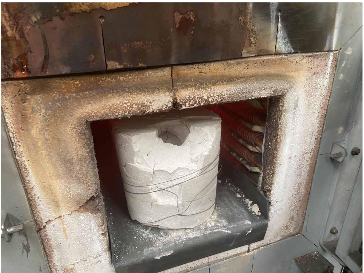
Obrázek 35: Praskání a rozpad poslední sádrové formy
