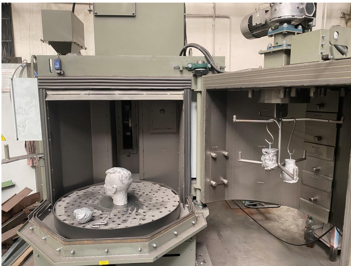
Obrázek 46: Vkládání do tryskacího zařízení
