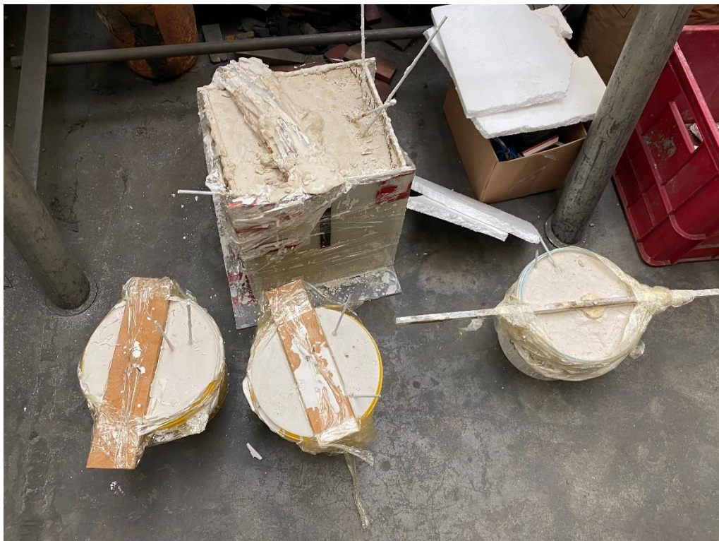
Obrázek 32: Odlité sádrové formy
