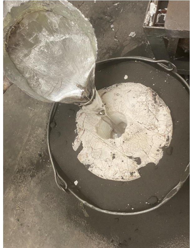
Obrázek 39: Samotné lití roztaveného kovu do sádrové formy
