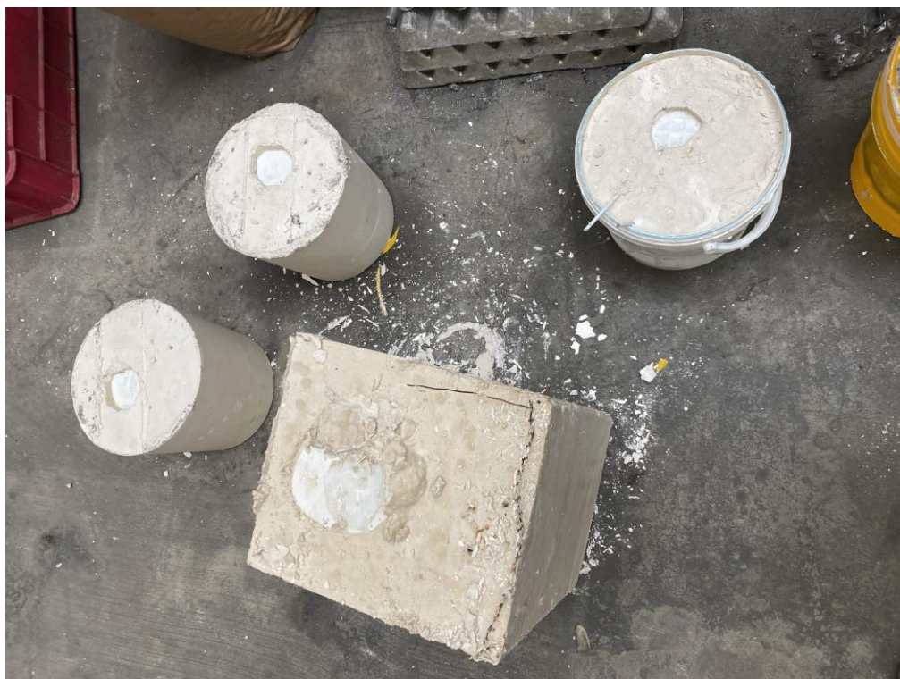
Obrázek 33: Odstranění formovacího rámu pro lepší schnutí
