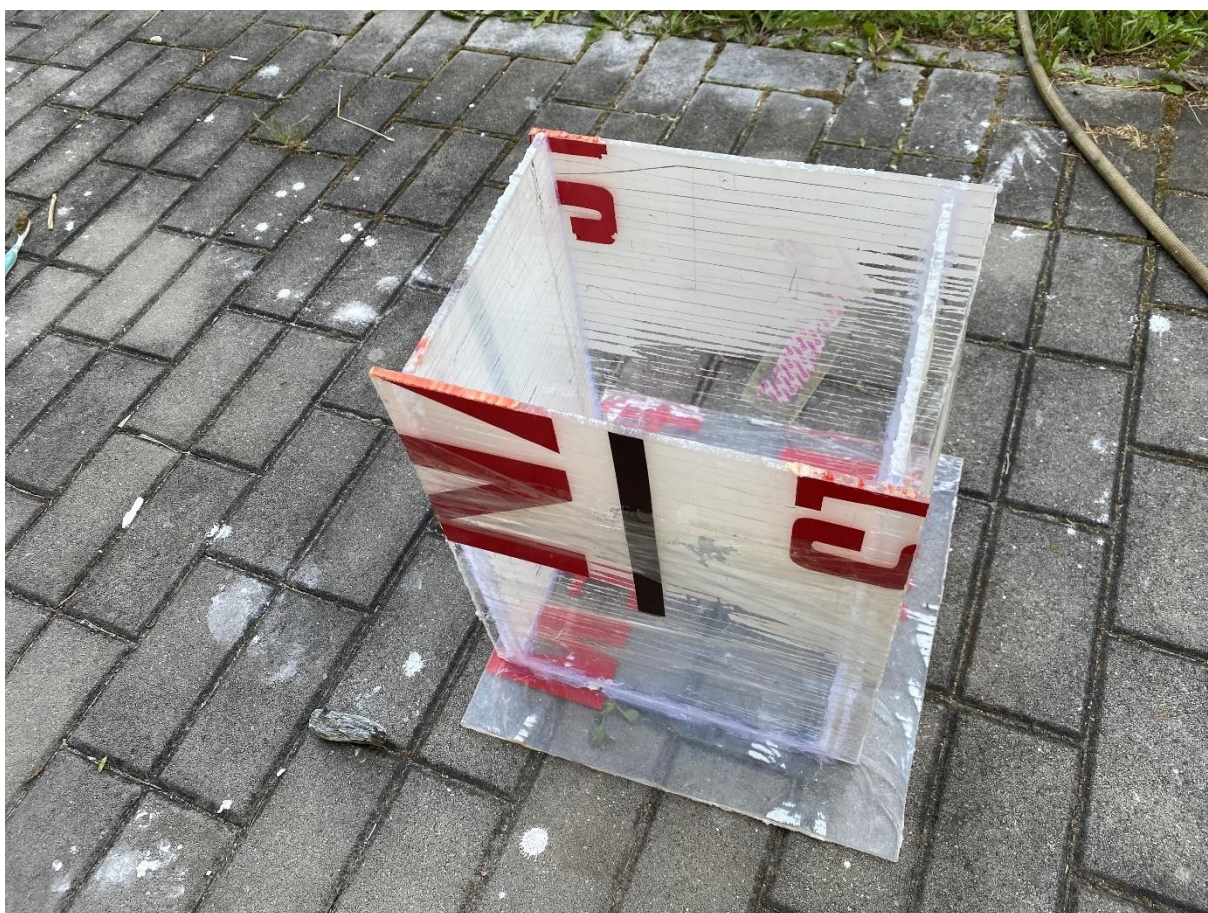
Obrázek 30: Výroba a konstrukce formovacího rámu
