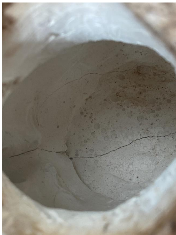
Obrázek 37: Praskliny a pórovitost povrchu vnitřku formy
