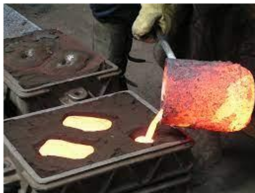
Obrázek 9: Gravitační lití do pískové formy, za použití formovacích rámu
