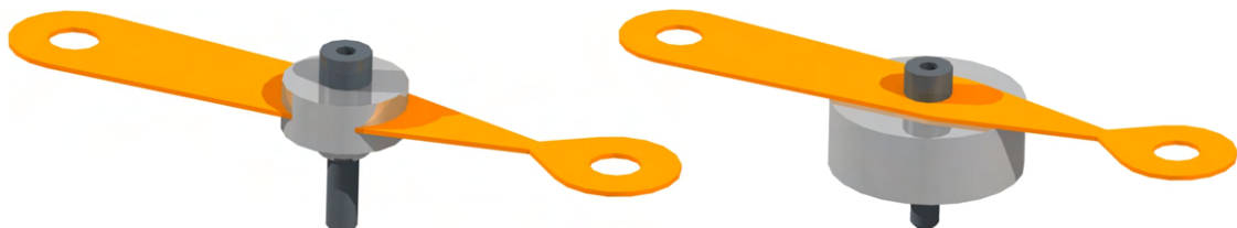
Obr. 6.3: Testované vzorky se závažími 44,7 g a 158,5 g
