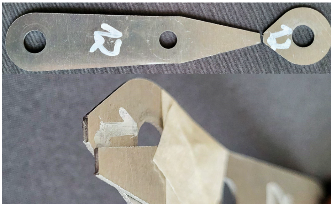
Obr. 7.6: Prasklý vzorek č. 12 po provedené zkoušce - druhá konfigurace
