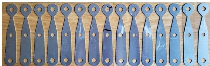
(a) Vyřezané vzorky z hliníku EN AW 6082 T6
