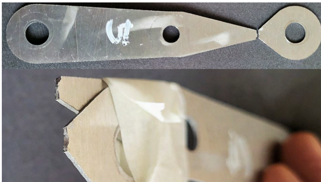
Obr. 7.4: Prasklý vzorek č. 5 po provedené zkoušce - první konfigurace
