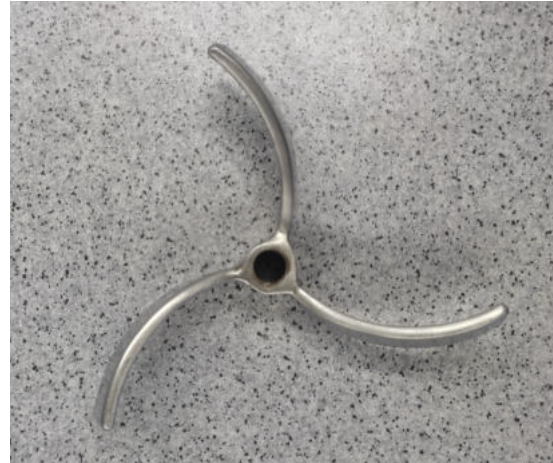
(b) Míchadlo se zakřivenými lopatkami
