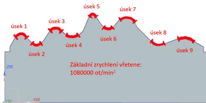
Obr. 51 Schématické znázornění míst s upravenou hodnotou zrychlení
