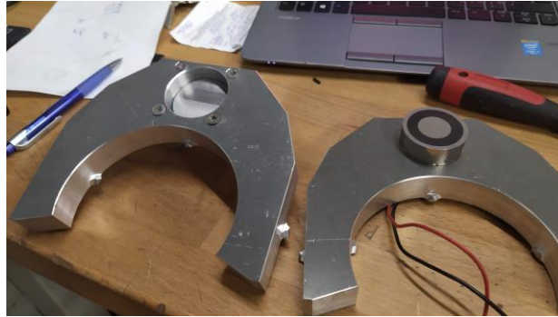
Obrázek 8: Úchyty vyřezané z polotovaru
