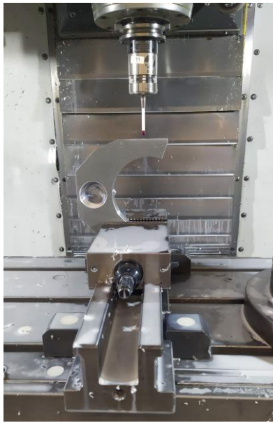
Obrázek 6: Obrobek upnutý ve stroji
