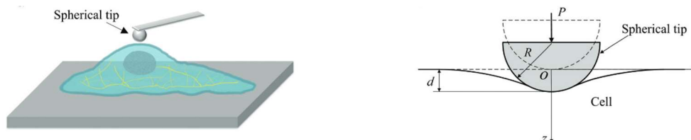
Obrázek 2.20: Schéma vtisku AFM s kulovým hrotem [50]
