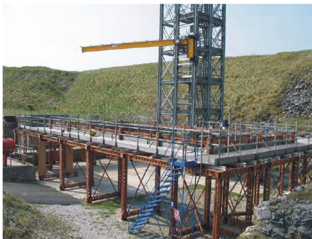
Obrázek 1.5: Speciální zařízení pro testování ochranných sítí, převzato z [28]
