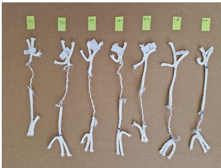
Obrázek 3.1: Vzorky po provedené tahové zkoušce – sada A
