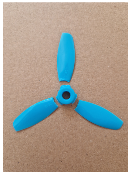
(b) Vrtule 2 po provedeném testu
