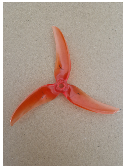
(b) Vrtule 5 po provedeném testu
