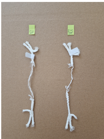
(a) Vzorky po kolizích, po tahové zkoušce
