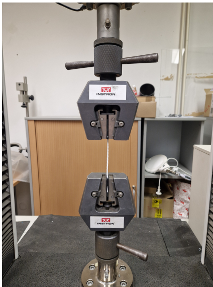
(a) Detailní upevnění vzorku v čelistech
