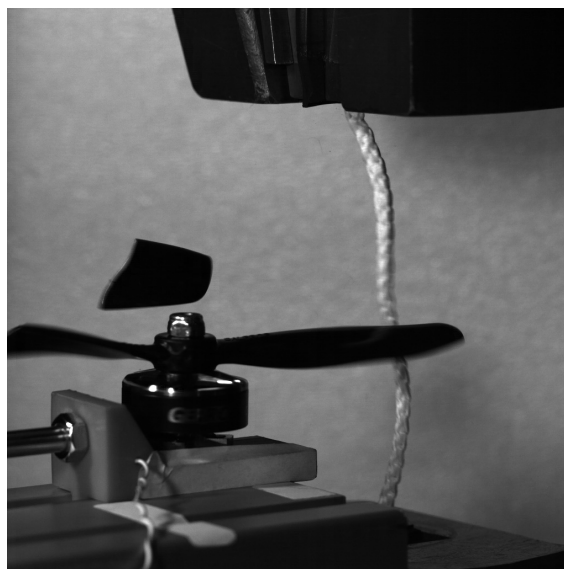
Obrázek 3.26: Snímek pořízený vysokorychlostní kamerou – laboratorní test vrtule 7, napnutí na 2 N
