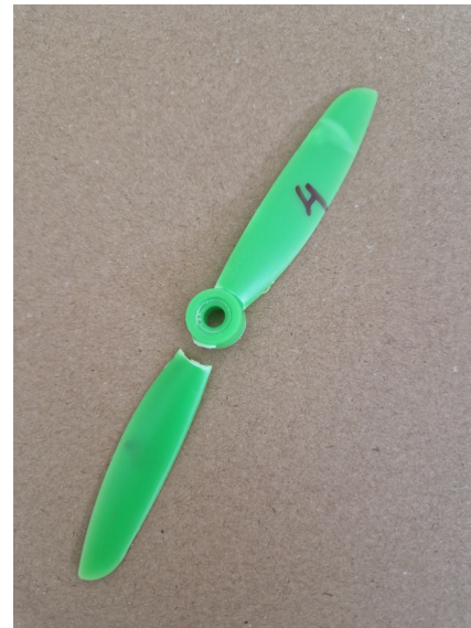
(b) Vrtule 9 po provedeném testu
