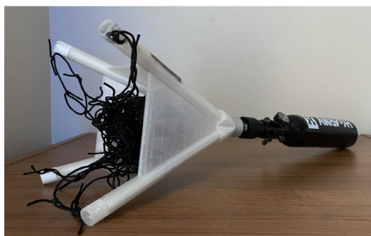
Obrázek 1.6: Vystřelovací zařízení pro zachycení UAV, převzato z [29]
