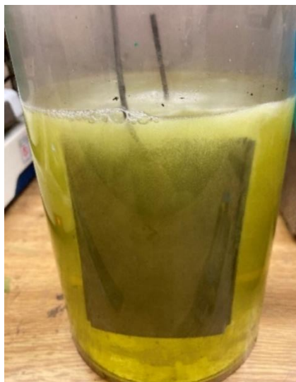
Obrázek 31: Mořený vzorek v nádobě s roztokem 15% HCl
