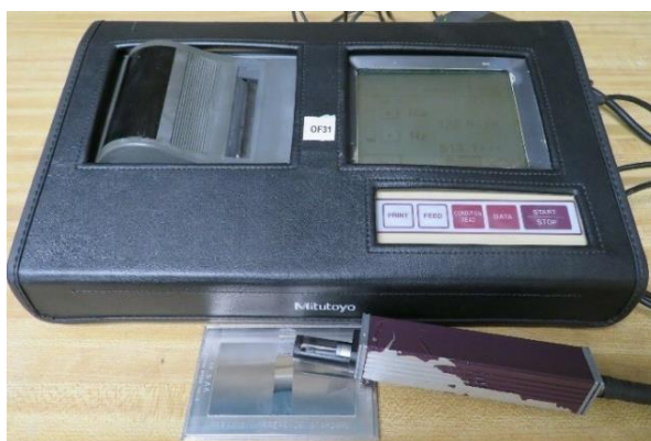
Obrázek 28: Drsnoměr Mitutoyo SJ-301 [52]
