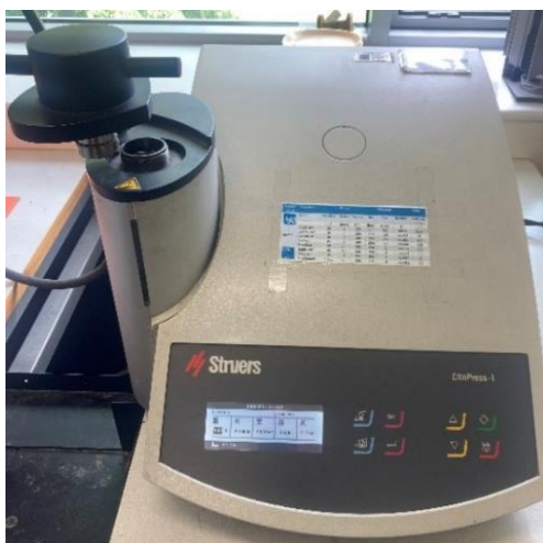
Obrázek 41: Automatický elektrohydraulický lis CitoPress - 1 značky Struers
