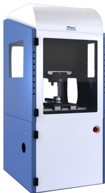
Obrázek 59: Tribometr MFT-5000 značky Rtec instruments [56]
