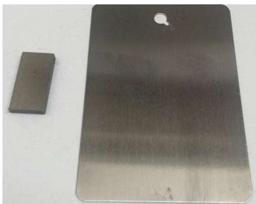
Obrázek 27: Testovací vzorky, levý - 15x30x4 mm, pravý - 76x152x0,81 mm
