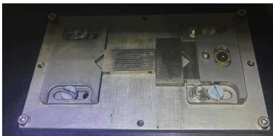
Obrázek 61: Aretace zkoušeného vzorku
