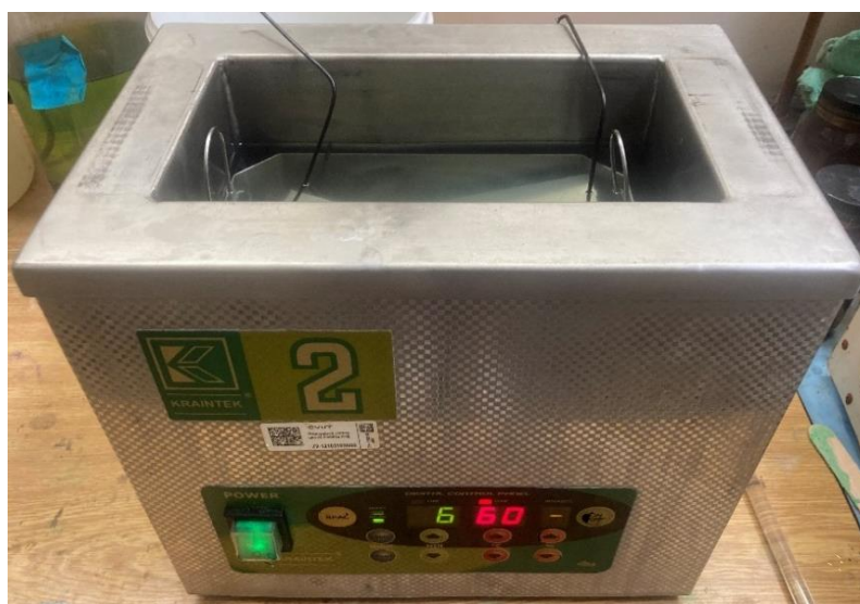
Obrázek 30: Laboratorní ultrazvuková vana K-2LE značky Kraintek
