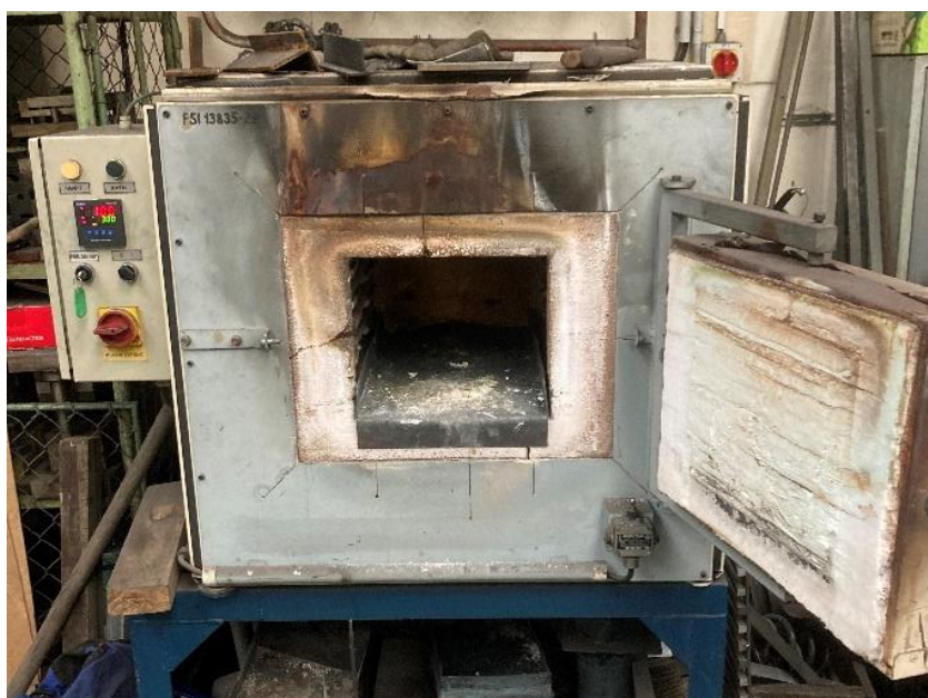
Obrázek 52: Keramická vypalovací pec ELSA-I-30/120
