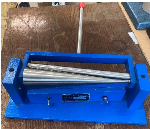
Obrázek 49: Kónický trn pro ohybovou zkoušku dle normy ČSN EN ISO 2819
