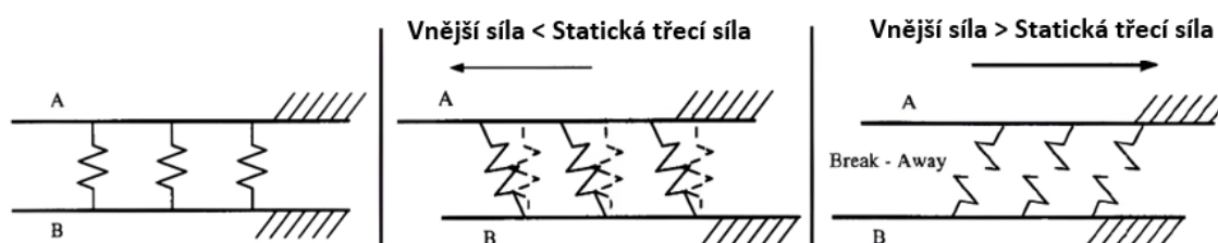
Obrázek 20: Schéma jevu Break - away force [49]
