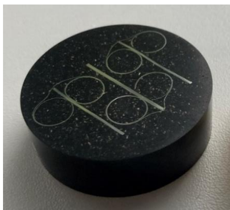
Obrázek 44: Metalografický výbrus (puk) vzorků s povlakem Ni-P-D
