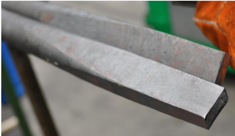
Obr. 23 Ukázka zařezaných konců vykovaných na bucharu
