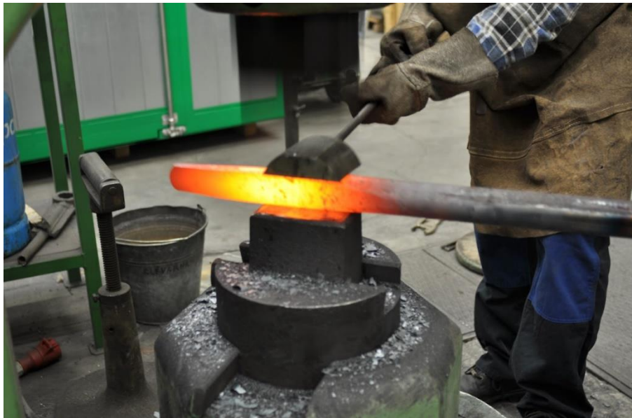
Obr. 21 Kování klínu na bucharu pomocí hladítka
