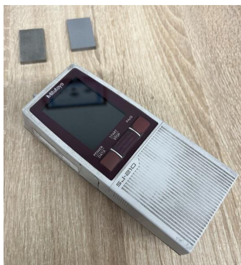
Obrázek 34 - Přenosný drsnoměr Mitutoyo Surftest SJ-210
