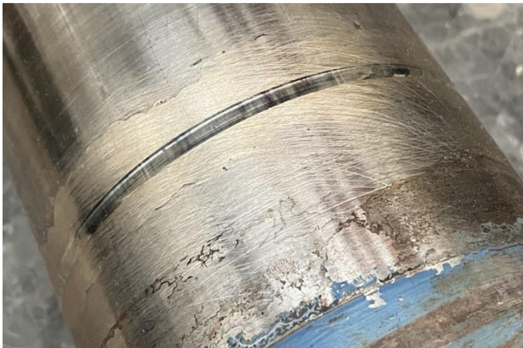
Obrázek 32 - Detail tepelně ovlivněné oblasti v oblasti návaru
