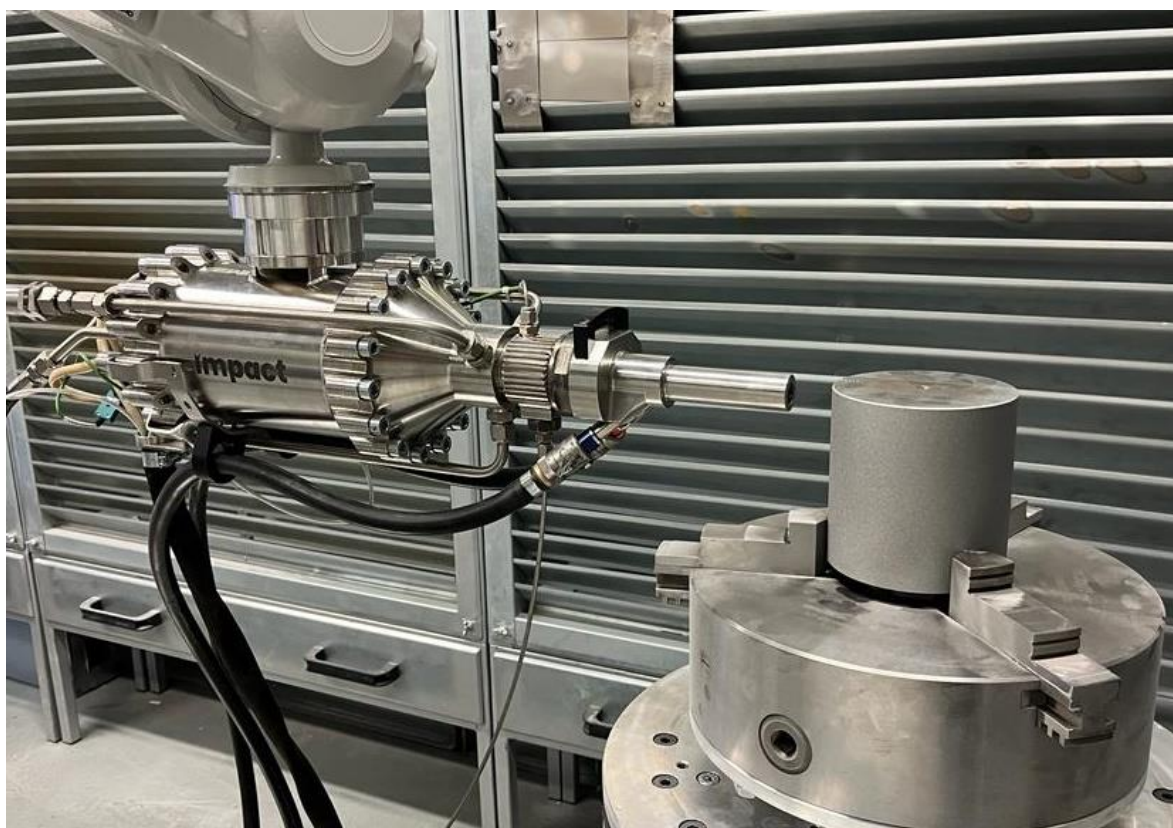
Obrázek 54 - Upnutý otryskaný čep
