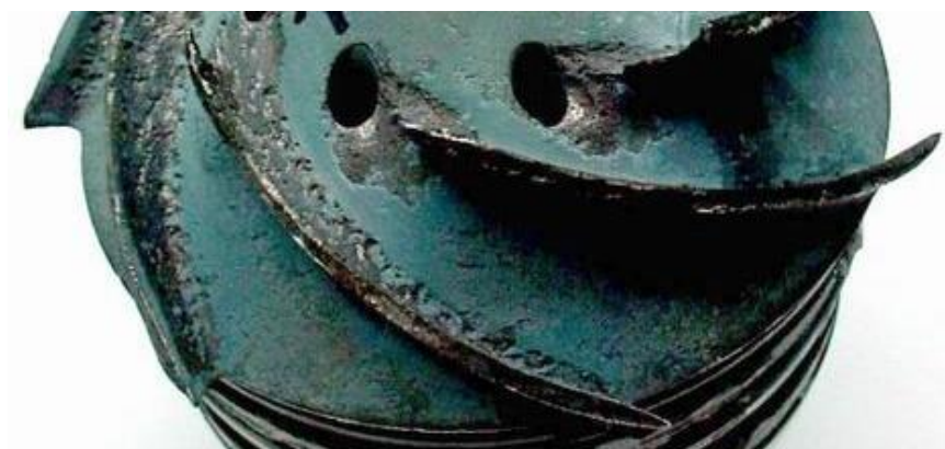
Obrázek 9 - Kavitačně opotřeбенé lopatkové kolo [30]
