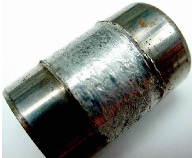
Obrázek 2 – Adhezivně opotřebený čep [27]
