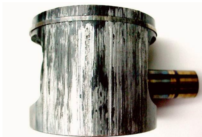
Obrázek 4 - Abrazivně opotřeбенý píst [28]
