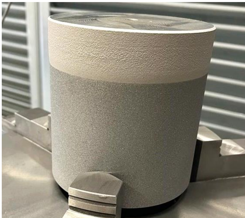
Obrázek 55 - Čep s naneseným nástřikem
