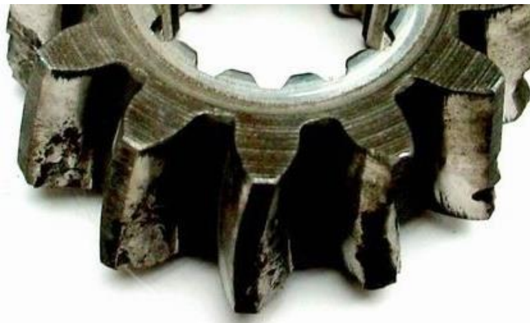
Obrázek 11 - Únavové opotřebení zubů pastorku [31]
