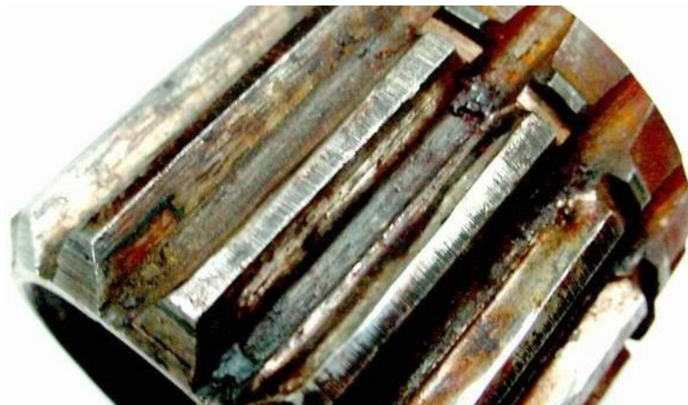
Obrázek 13 - Vibračně opotřebovaná drážkovaná hřídel [32]
