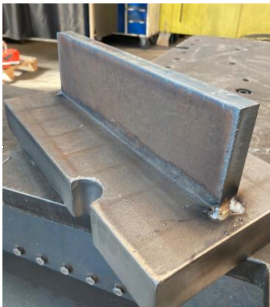
Obrázek 40 - Postehovaný zkušební kus
