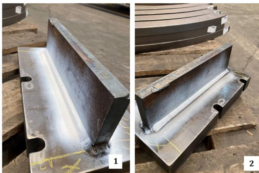
Obrázek 44 -Magnetická zkouška prvního svaru, 1 – před provedení zkoušky, 2 – po provedení zkoušky
