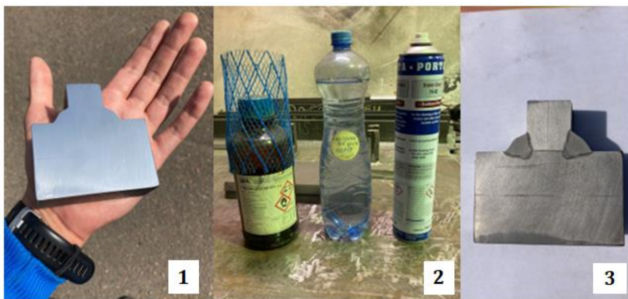
Obrázek 49 - Průběh makroskopické kontroly, 1 - zbroušený povrch vzorku, 2 - přípravky pro naleptání a očištění vzorku, 3 - naleptaný vzorek
