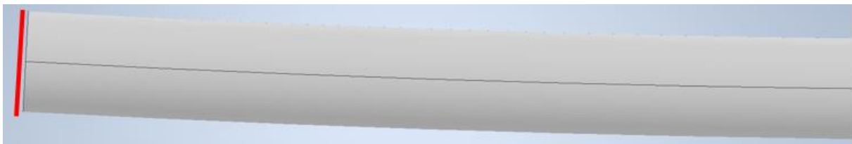
Obr. 43: Vyrovnání polotovaru při řezu vzhledem k prohnuté ose polotovaru.
