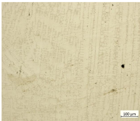
Obrázek 31 Míra a uskupení porozity Vzorku 2
