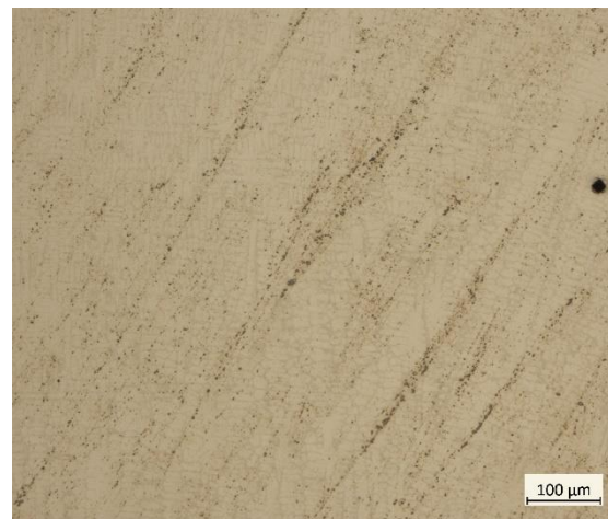
Obrázek 35 Míra a uskupení porozity Vzorku 4
