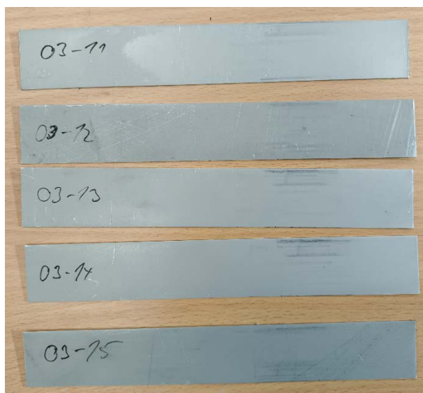
Obr. 48: Naměřené vzorky sady 03 (rychlost tažení 600 mm/min)
