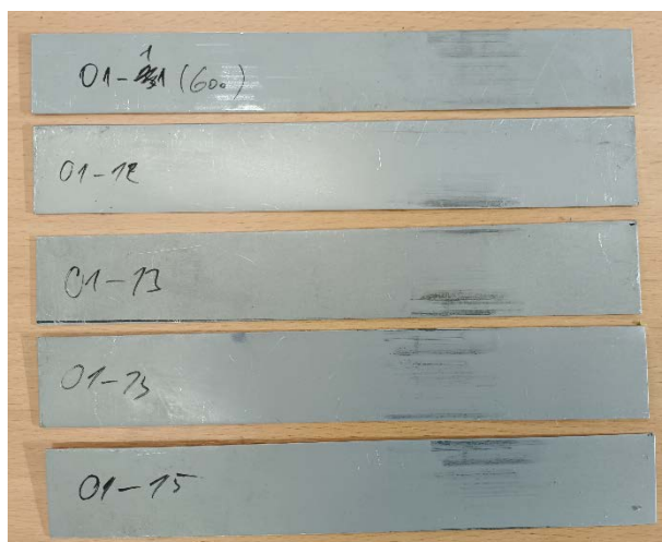
Obr. 46: Naměřené vzorky sady 01 (rychlost tažení 600 mm/min)
