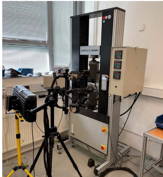
Obr. 22: Univerzální trhací stroj LabTest 5.100SP1
