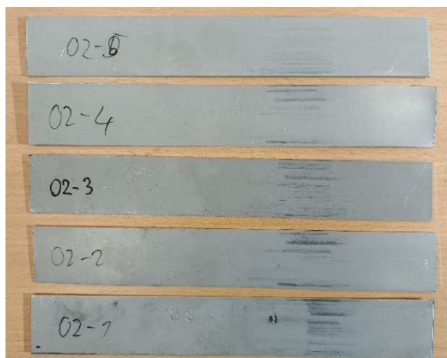
Obr. 41: Naměřené vzorky sady 02 (rychlost tažení 20 mm/min)
