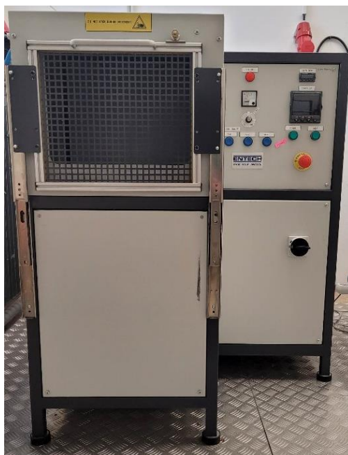
Obrázek 23 Cyklovací pec od společnosti ENTECH.
