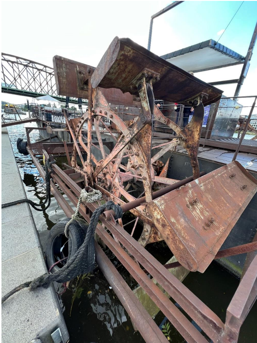
Obr. 14.: Rekonstruované natáčivé lopatkové koleso plavidla kotvicího na Výtoni v Praze
