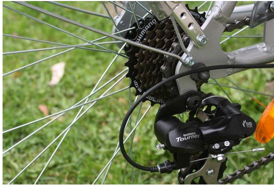
Obr. 17.: Řetězová převodovka u jízdního kola [22]
