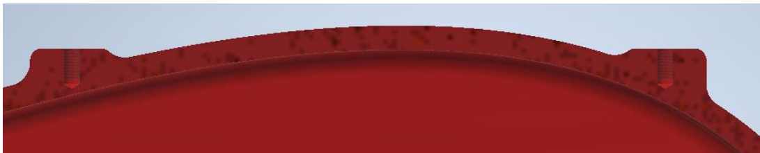
Obr. 40.: Nálitky se závitem pro montáž stavěcích šroubů
