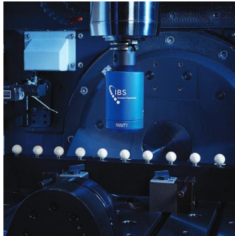
Obr. 5.2: bezkontaktní sonda IBS trinity při najíždění na artefakty [30].
