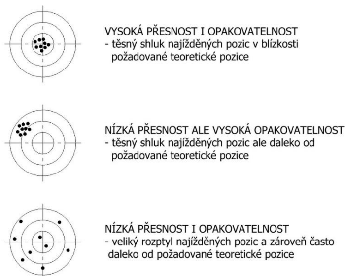
Obr. 5.1: schematické zobrazení přesnosti a opakovatelnosti [22].
