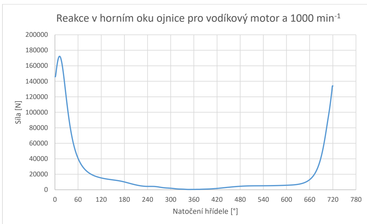
Graf 11 - Výsledná reakce mezi pístní skupinou a horním okem ojnice pro vodíkový motor a 1000 \text{ min}^{-1}
