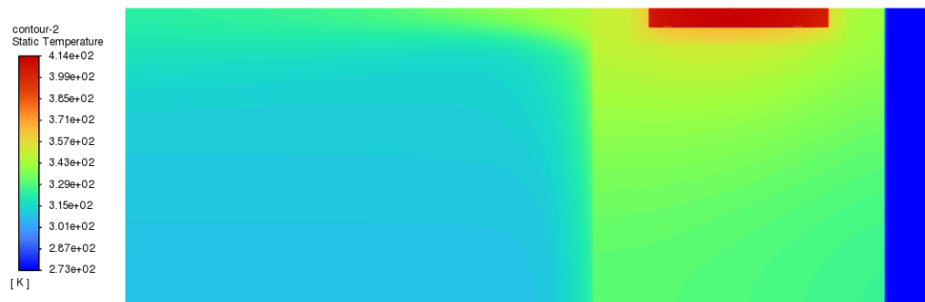
Obrázek 28: Rozložení teplot při hmotnostním toku 375 kg/h v řezu B
