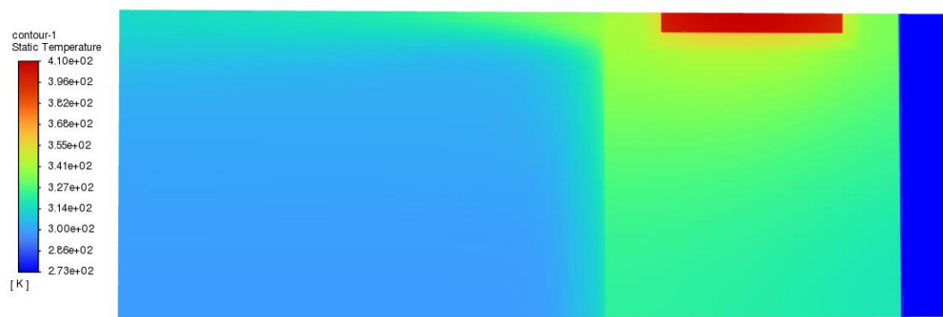
Obrázek 31: Rozložení teplot při hmotnostním toku 450 kg/h v řezu B
