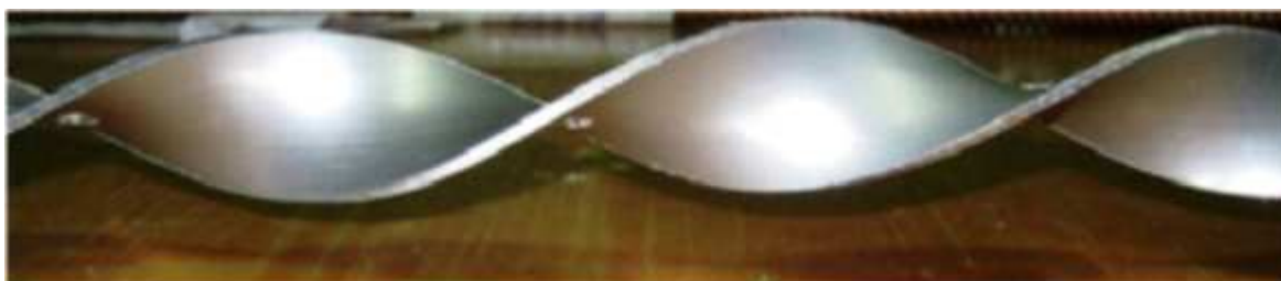
Obr. 15 Typická konfigurace zkroucené pásky (Hasanpour, a další, 2014)
