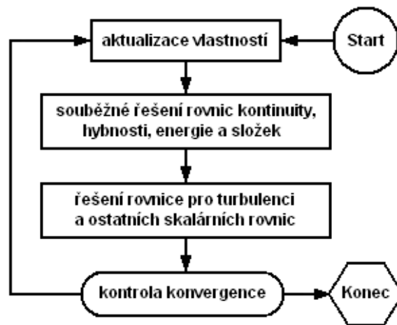
Obr. 21 Diagram algoritmu metody korekce hustoty
